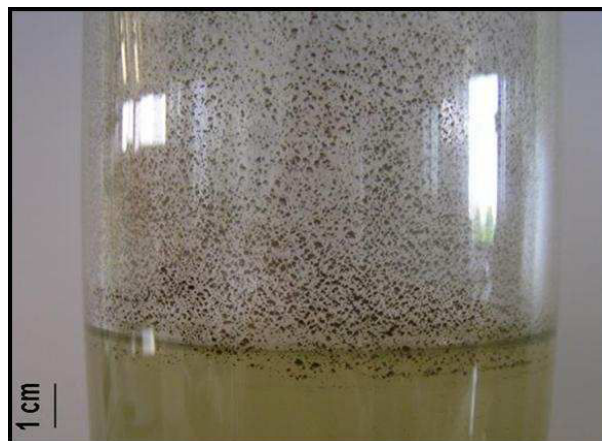
Figure 38 : « Particules hydrophobes » collées sur les parois des allonges lors du fractionnement utilisant les résines
