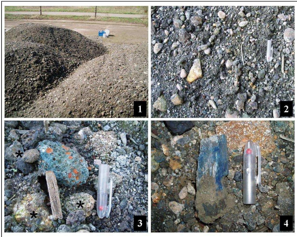
Figure 22 : Photos du matériel initial de Neuves Maisons à T-1. (1.1) Observation générale des tas, (1.2) vue sur les constituants hétérométriques sur le flanc d'un tas, (1.3) et (1.4) zoom sur certains constituants : les laitiers sont repérés par une étoile.
