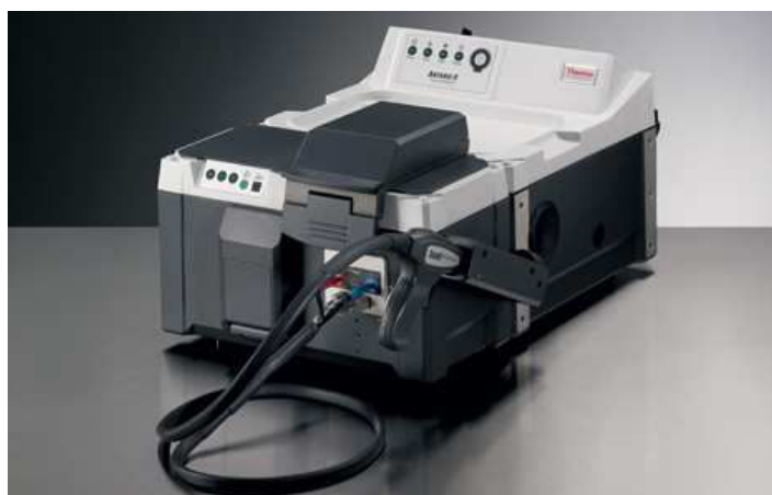
Figure 41. Spectromètre proche infrarouge Thermofisher scientifique Antaris II et sonde in-situ
