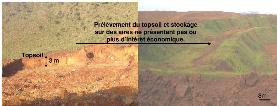
**Figure 1-7** : Nature et devenir des topsoils recouvrant les gisements exploitables
