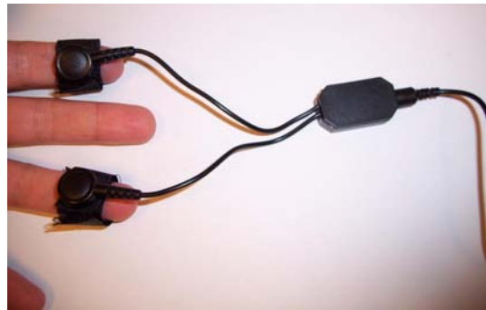
FIGURE 3.2 – Emplacement du capteur de conductance de peau
