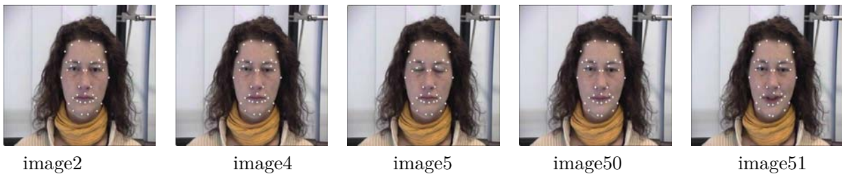
FIGURE 2.10 – Le suivi des points caractéristiques dans une séquence vidéo avec une fenêtre de recherche de taille 10 \times 10
