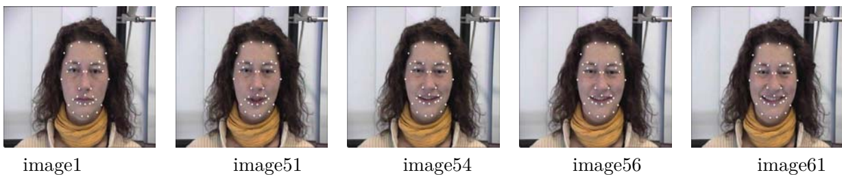
FIGURE 2.12 – Le suivi des points caractéristiques dans une séquence vidéo avec une fenêtre de recherche de taille 30 \times 30
