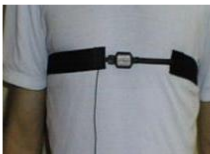
FIGURE 3.8 – Capteur du volume respiratoire
