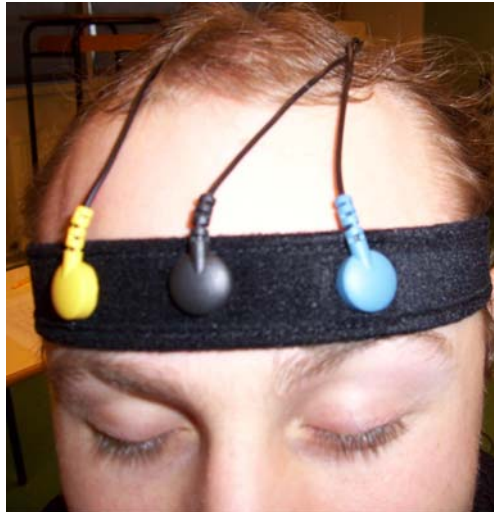
FIGURE 3.4 – Emplacement du capteur du signal EMG
