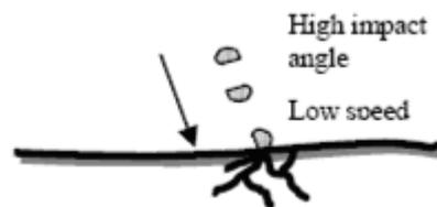
Figure I-4 : Erosion due à la fatigue de surface [10].
