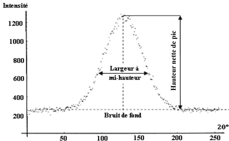
Figure IV-8 : Illustration d'un pic de diffraction.
