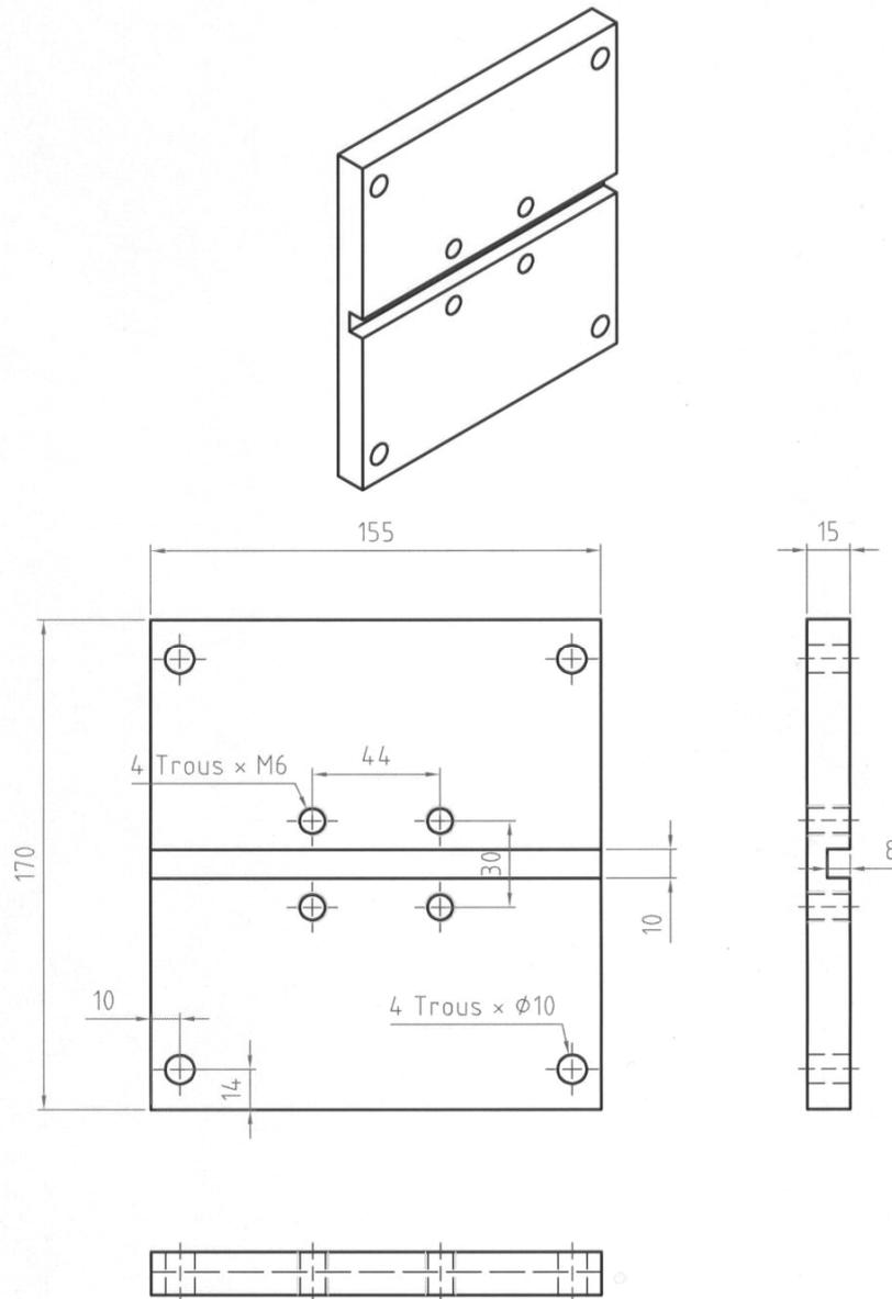
Figure II-15 : Dessin et dimensions du montage porte éprouvette.
