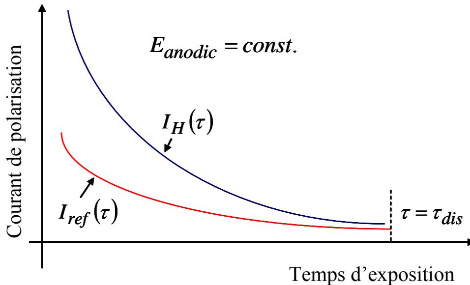
Figure II-39 : Exemple de déchargement d'hydrogène sous potentiel anodique [9-10].
