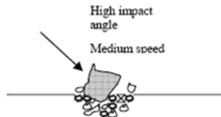
Figure I-6 : Erosion par rupture fragile [10].
