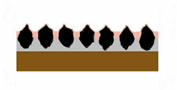
Figure II-10 : Forme des grains du corindon.
