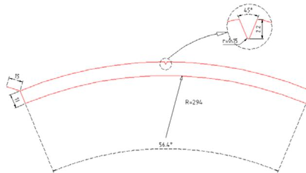
Figure III-13 : Géométrie de l'éprouvette de fatigue : Tuile Romaine.
