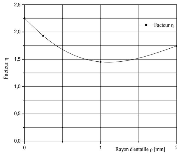
Figure I-42 : Evolution du coefficient η avec le rayon d'entaille (cas d'une éprouvette Charpy V) [83-84].
