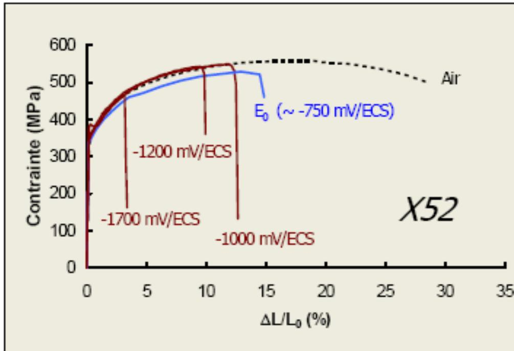
Figure I-49 : Courbe de traction d'un acier X52 [95].
