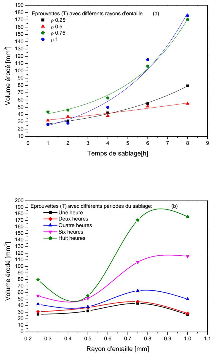
Figure II-21 : Evaluation du volume érodé dans le sens transversal en fonction de :
