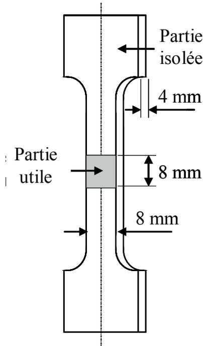
Figure II-37 : Eprouvette de chargement/déchargement en hydrogène.
