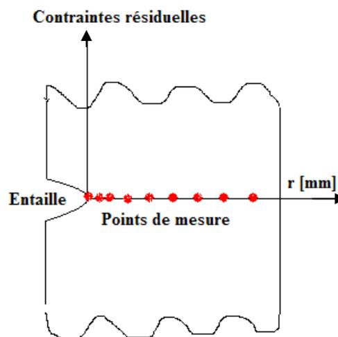
Figure IV-12 : Schéma des points des mesures.
