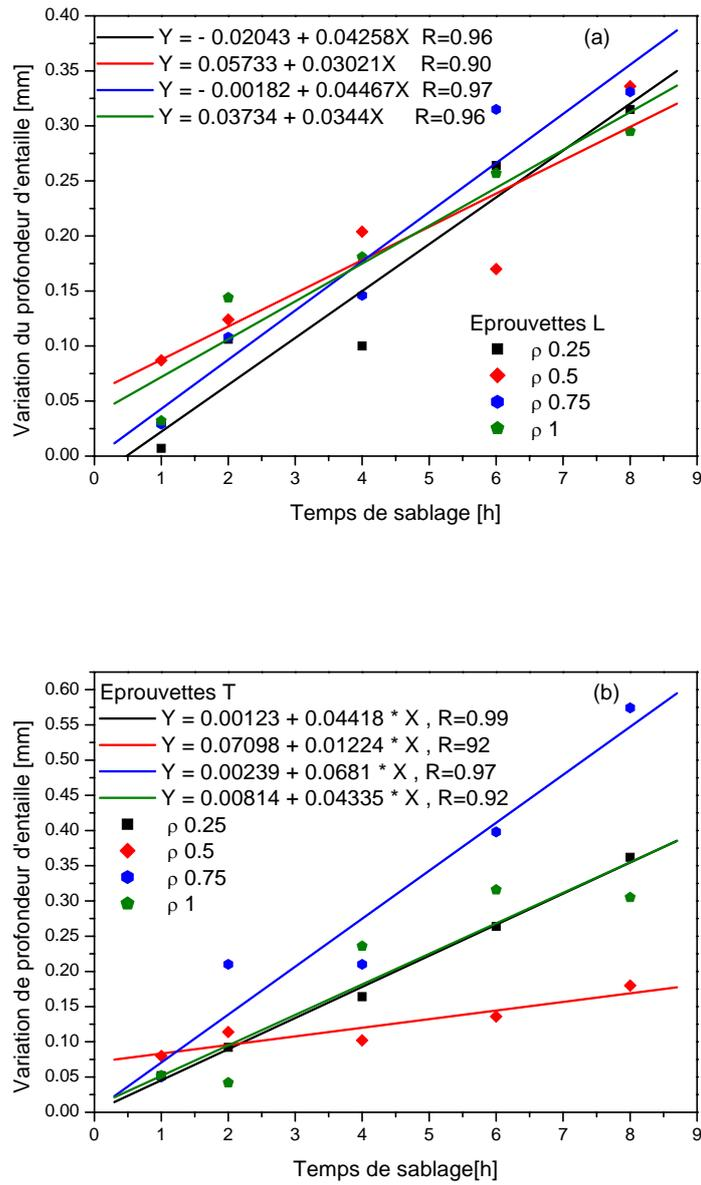
Figure II-30 : Variation de profondeur d'entaille pendant le sablage dans les deux sens :
