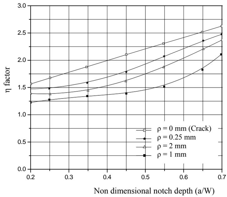
Figure I-43 : Evolution du facteur η en fonction de la profondeur relative [70].
