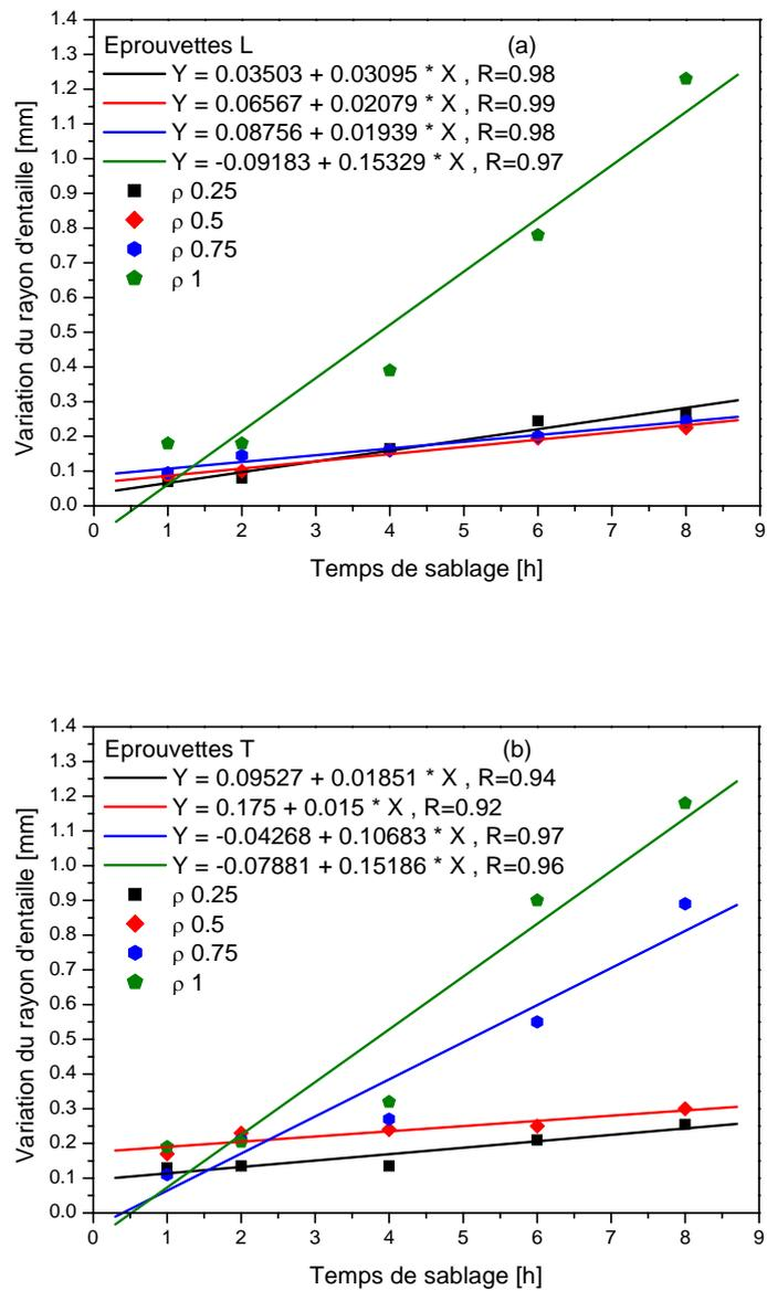
Figure II-28 : Variation du rayon d'entaille pendant le sablage dans les deux sens :
