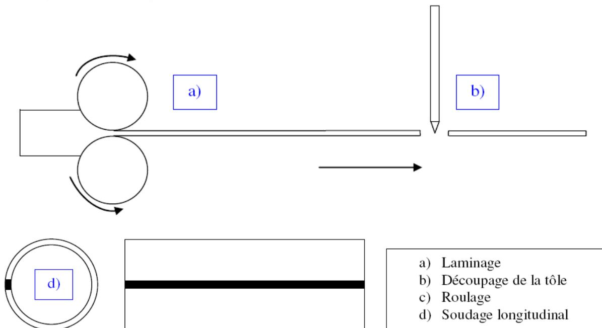
Figure II-2 : Procédé de fabrication d'un tuyau.
