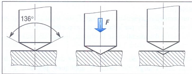
a) Principe de l'essai Vickers
