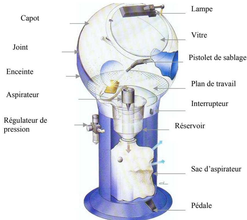
Figure II-8 : Schéma de la sableuse Blaster 2700.
