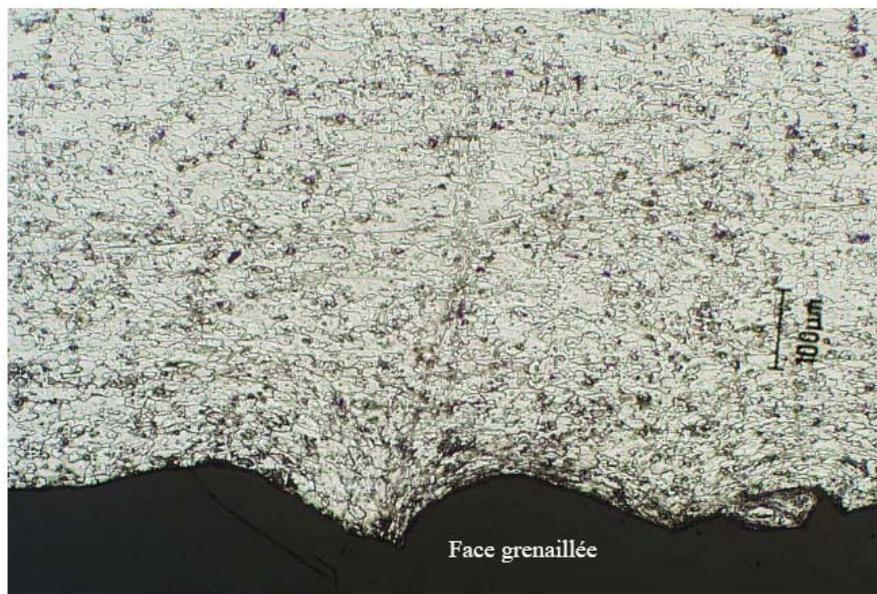
Figure I-31 : Micrographie d'un Al2017A grenailé.
