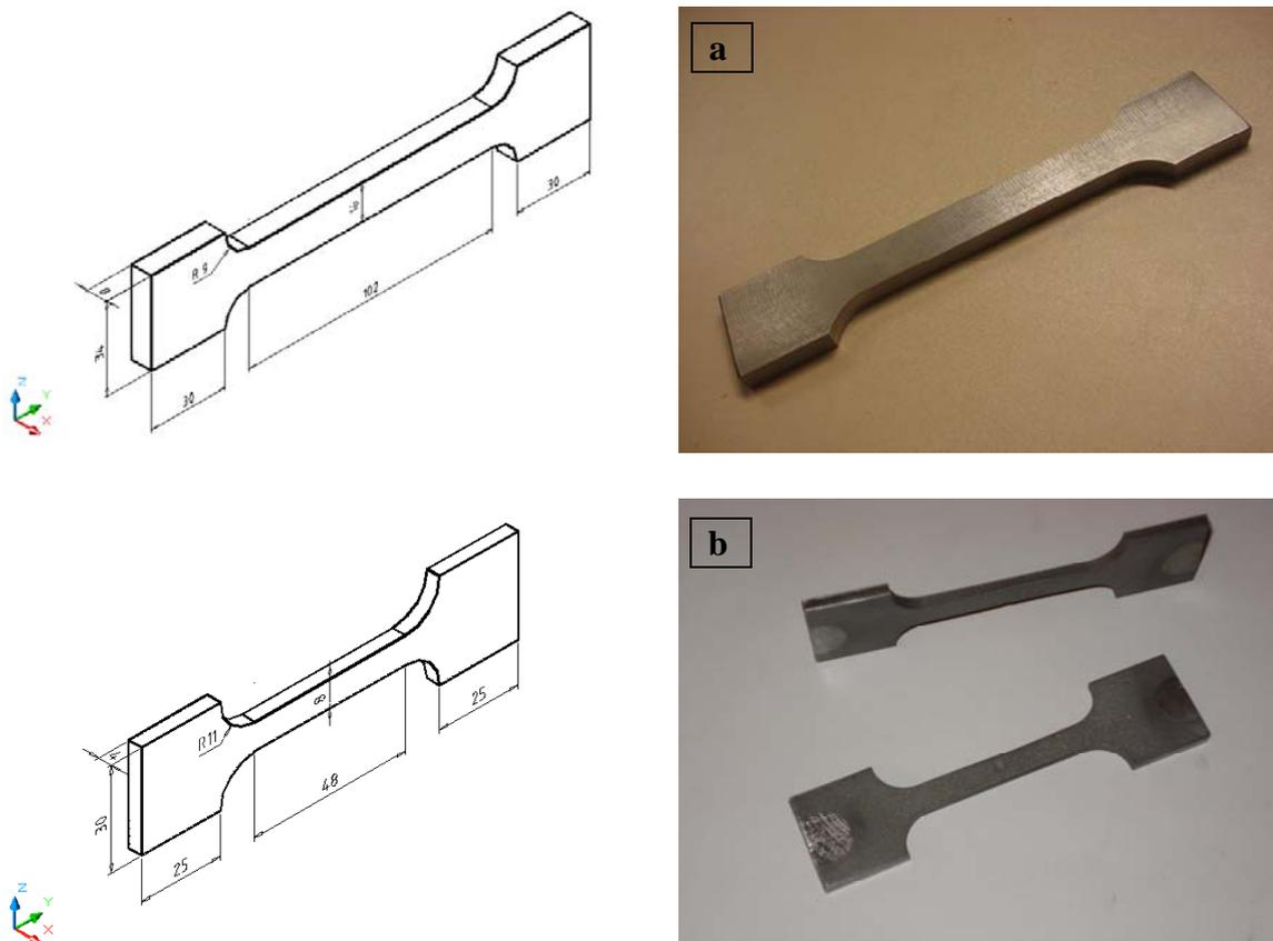
Figure III-1 : Géométrie des éprouvettes de traction :
