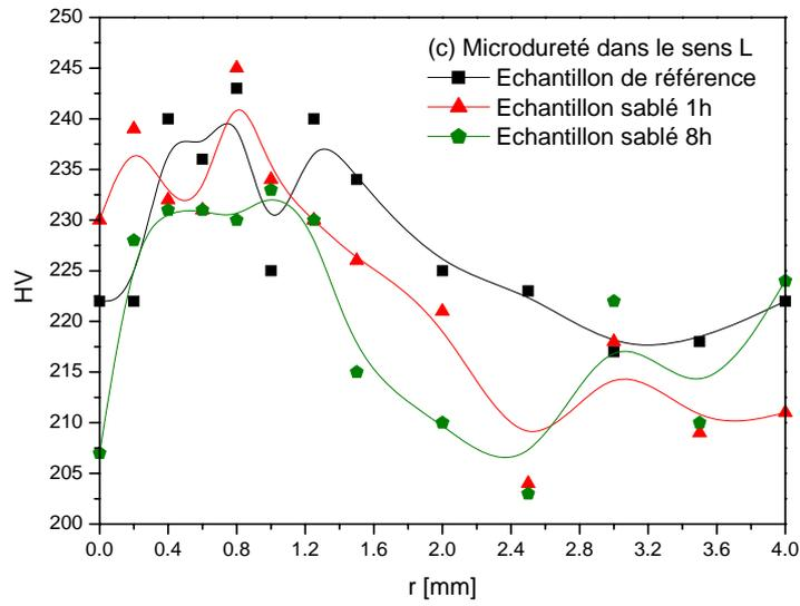
Figure IV-24 : Variation de la microdureté  $HV$  au fond d'entaille des échantillons Charpy L, en fonction du temps de sablage :
