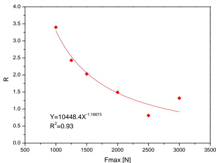
Figure III-19 : Variation du gain en durée de vie en fonction de la charge maximale appliquée.
