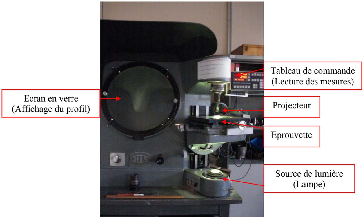
Figure II-26 : Machine de mesure du profil d'entaille.
