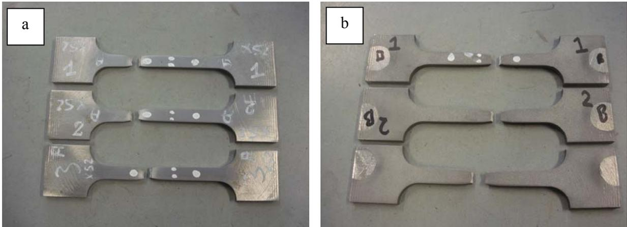
**Figure III-6 : Eprouvettes T après la rupture :**
