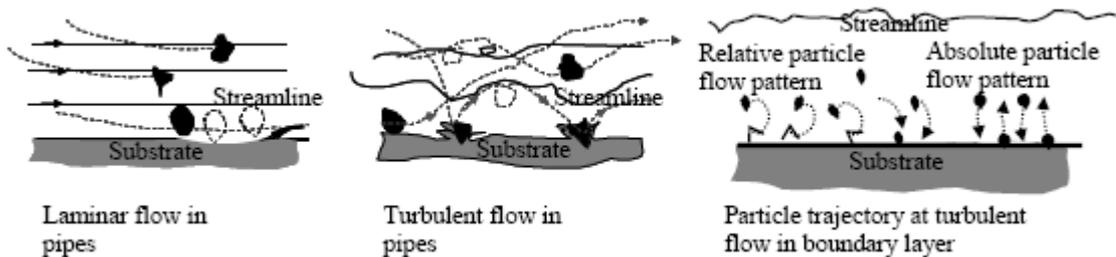
Figure I-12 : Effet des conditions du flux sur l'érosion.
