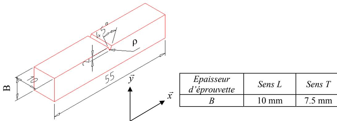
Figure IV-11 : Caractéristiques géométriques des éprouvettes.
