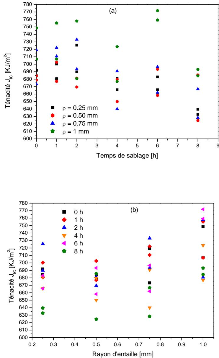
Figure III-11 : Variation de ténacité de l'acier API 5L X52, dans le sens longitudinal (L), en fonction du :
