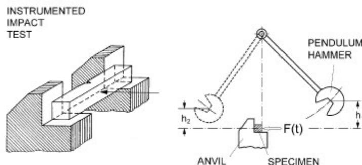
Figure I-37 : Schéma de l'instrument d'essai Charpy.
