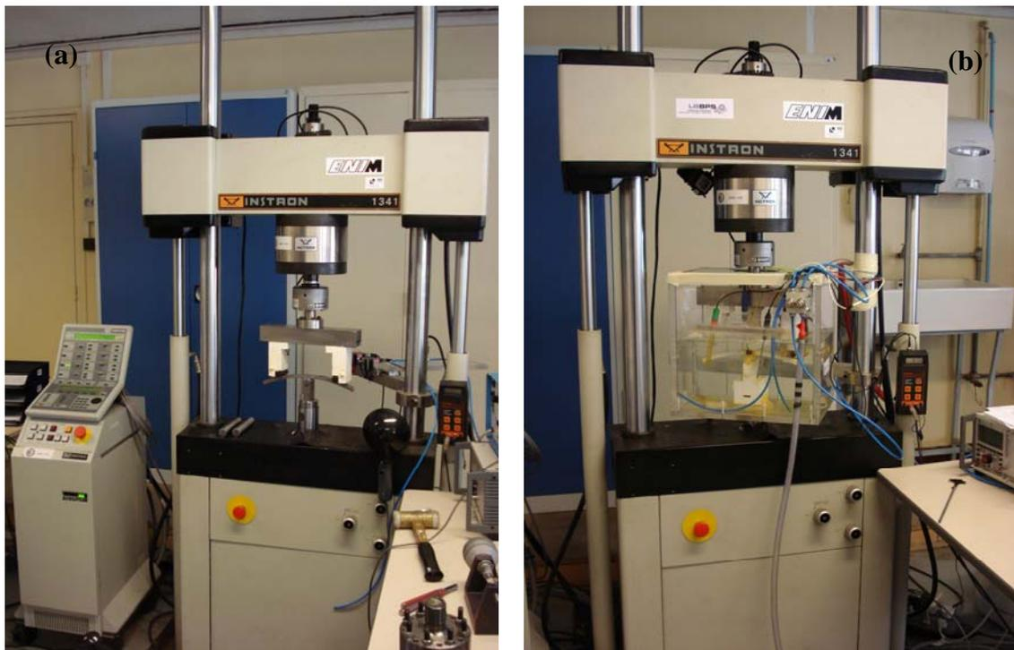
**Figure III-16 : Machine de traction/compression INSTRON 1341 :**
