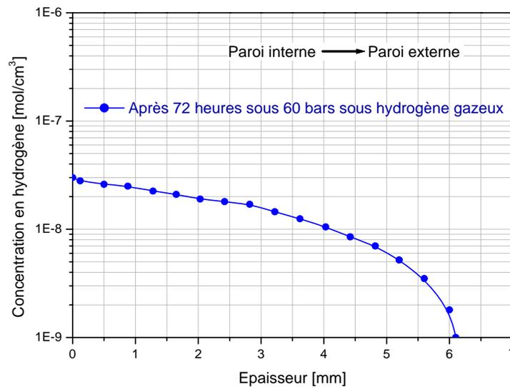
Figure II-43 : Evolution de la concentration en hydrogène dans l'épaisseur du tuyau.
