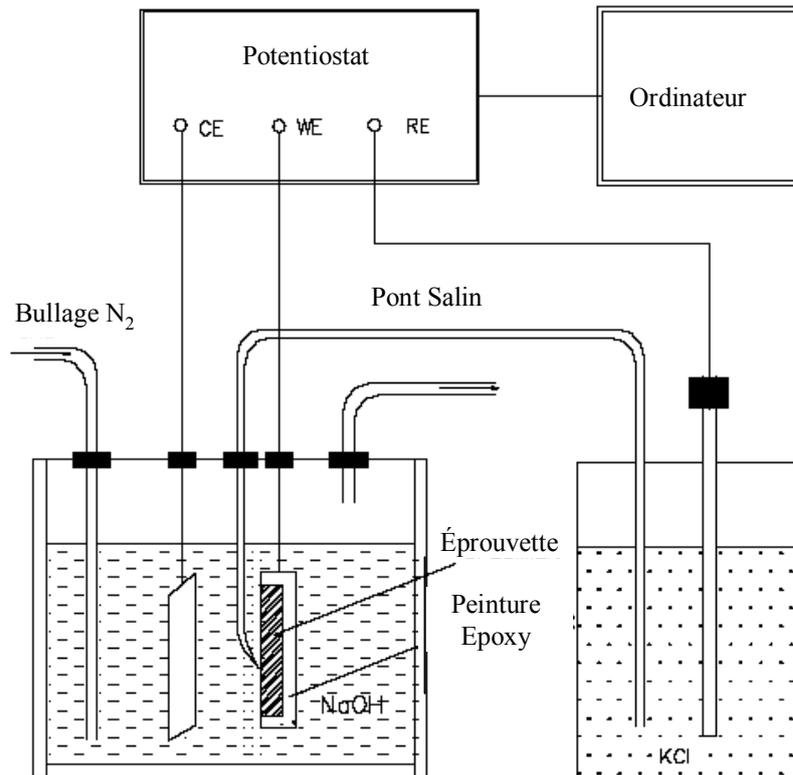
Figure II-38 : Cellule de chargement électro-chimique.
