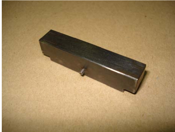
Figure III-10 : Outil pour centrer l'éprouvette sur les appuis.
