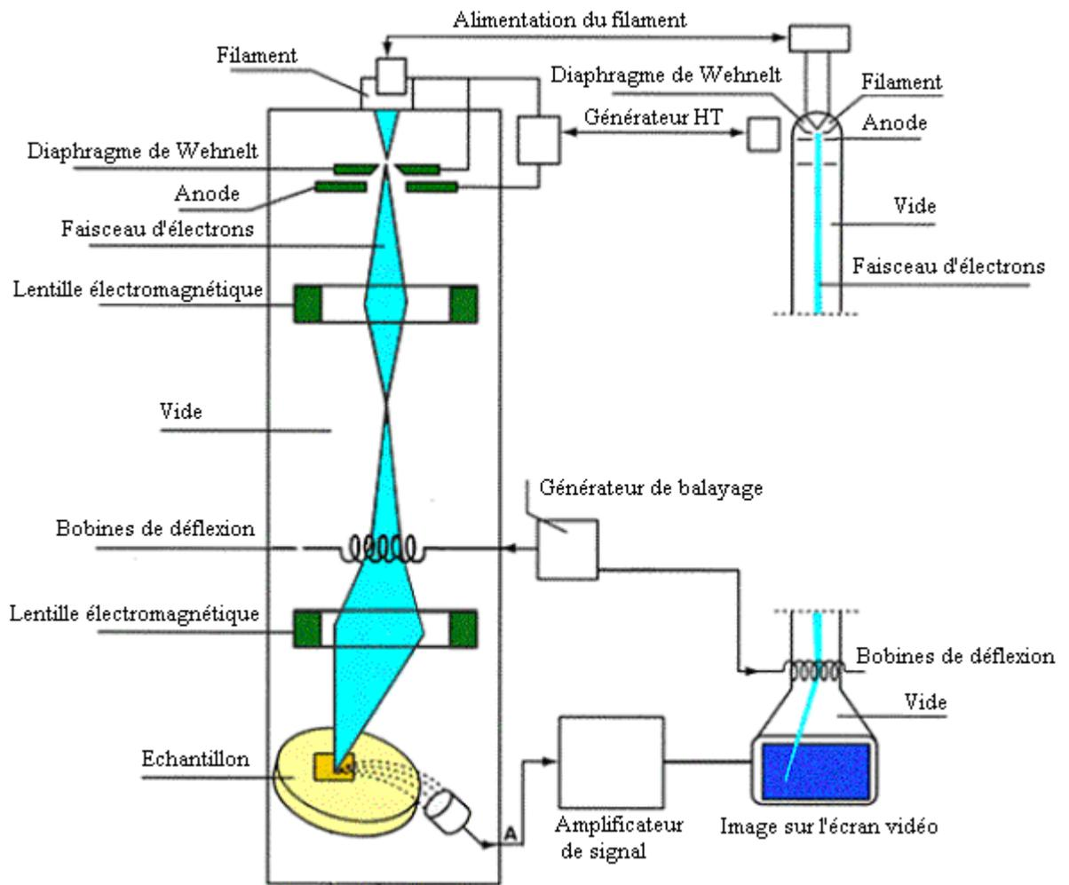
Figure IV-3 : Schéma de base d'un MEB.
