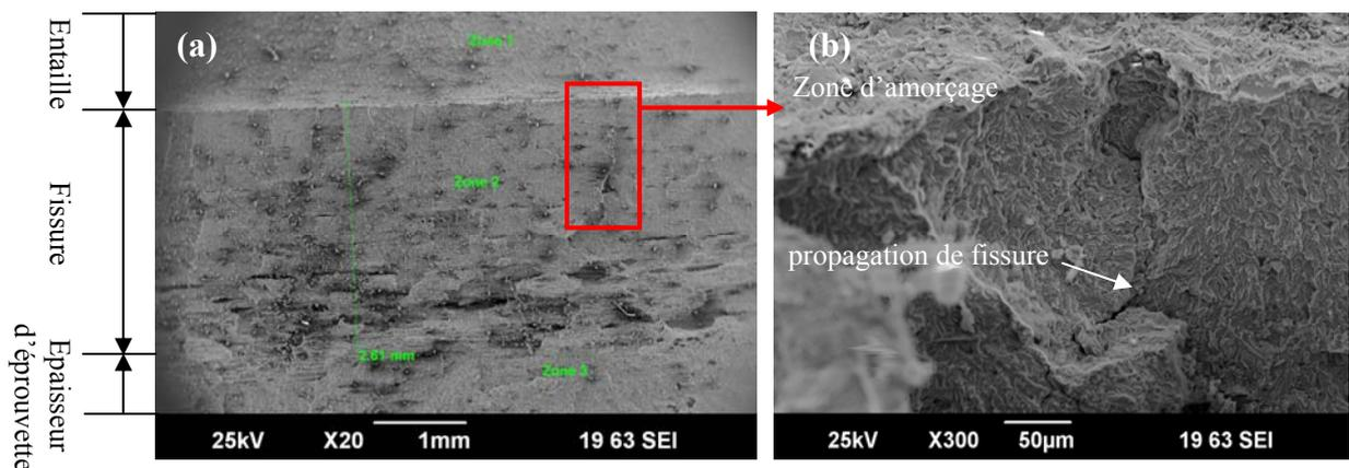
**Figure IV-6 : Faciès de rupture d'éprouvette de fatigue sablée :**
