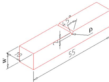
Figure II-17 : Géométrie d'éprouvettes.
