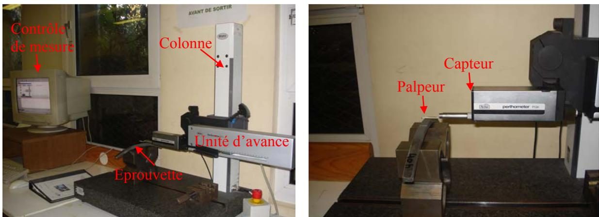
Figure II-22 : Appareil de mesure de rugosité de surface.
