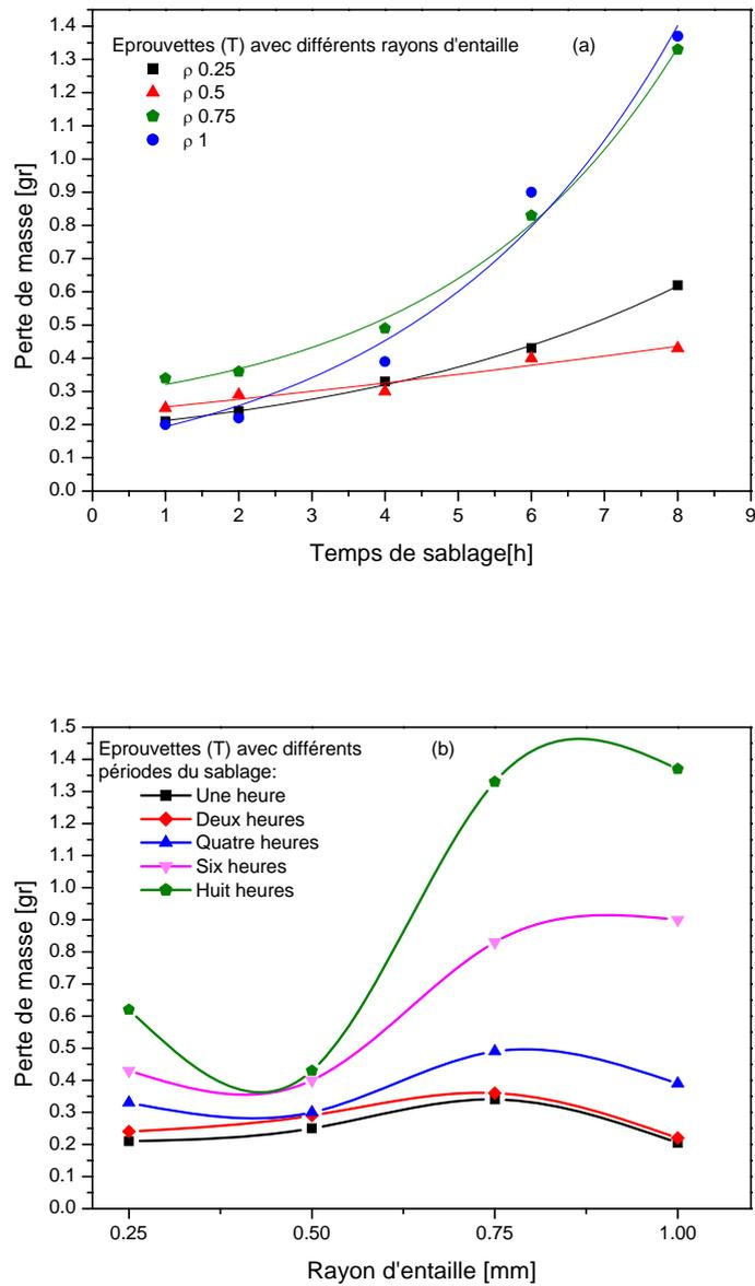
Figure II-19 : Evaluation de la perte de masse dans le sens transversal en fonction de :
