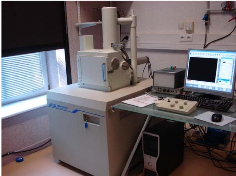
Figure IV-1 : Microscope électronique à balayage 6490W.
