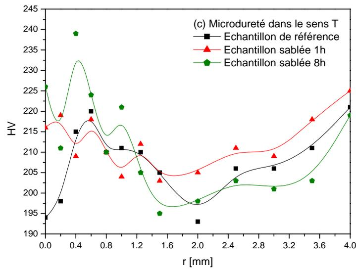
Figure IV-25 : Variation de la microdureté  $HV$  au fond d'entaille des échantillons Charpy T, en fonction du temps de sablage :
