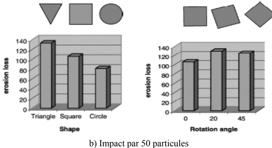
Figure I-15 : Erosion due à des particules de différentes formes (Chen et Li, 2003) [36].
