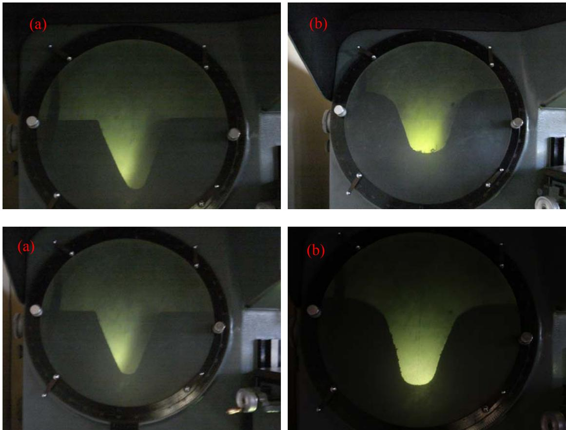
Figure II-27 : Forme du profil d'entaille pour deux éprouvettes :
