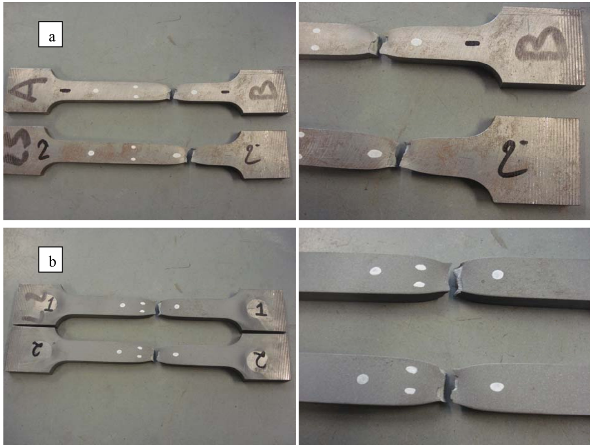
Figure III-4 : Epruvettes L après rupture : a) Epruvettes de référence, b) Sablées pendant 8 heures.
