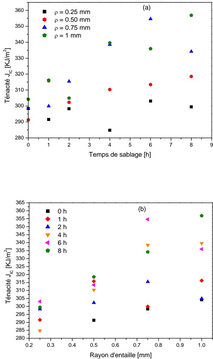
Figure III-12 : Variation de ténacité de l'acier API 5L X52, dans le sens transversal (T), en fonction du :
