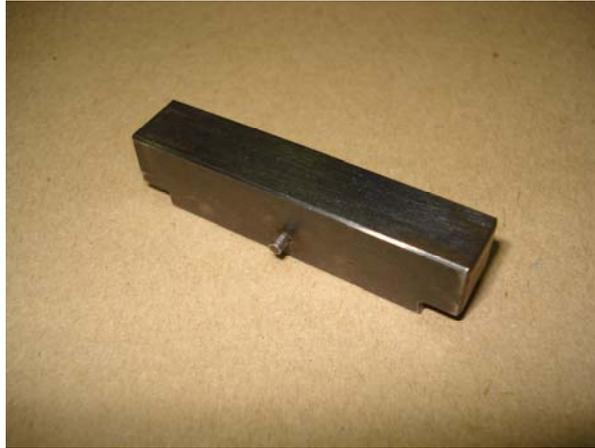
Figure III-10 : Outil pour centrer l'éprouvette sur les appuis.
