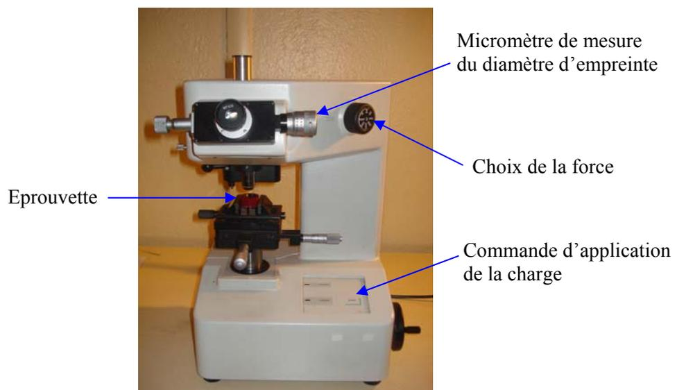
Figure IV-22 : Microduremètre Vickers.
