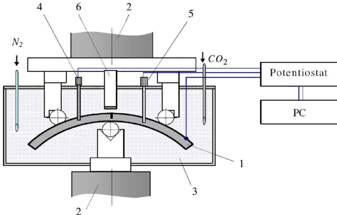
Figure II-36 : Cellule d'électrolyse.
