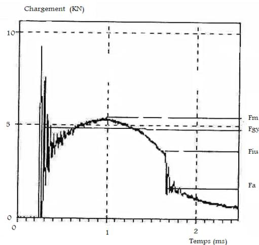
**Figure I-40 : Chargement enregistré (essai Charpy) [70, 71].**
