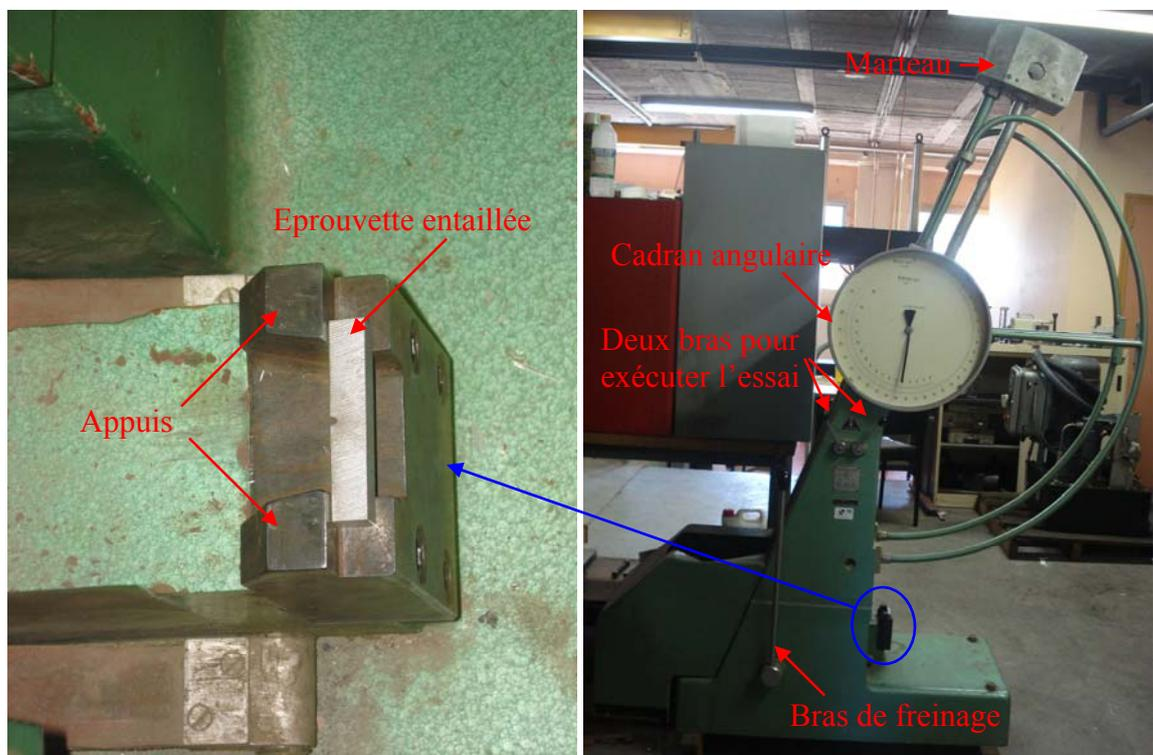
Figure III-9 : Machine Charpy utilisée.
