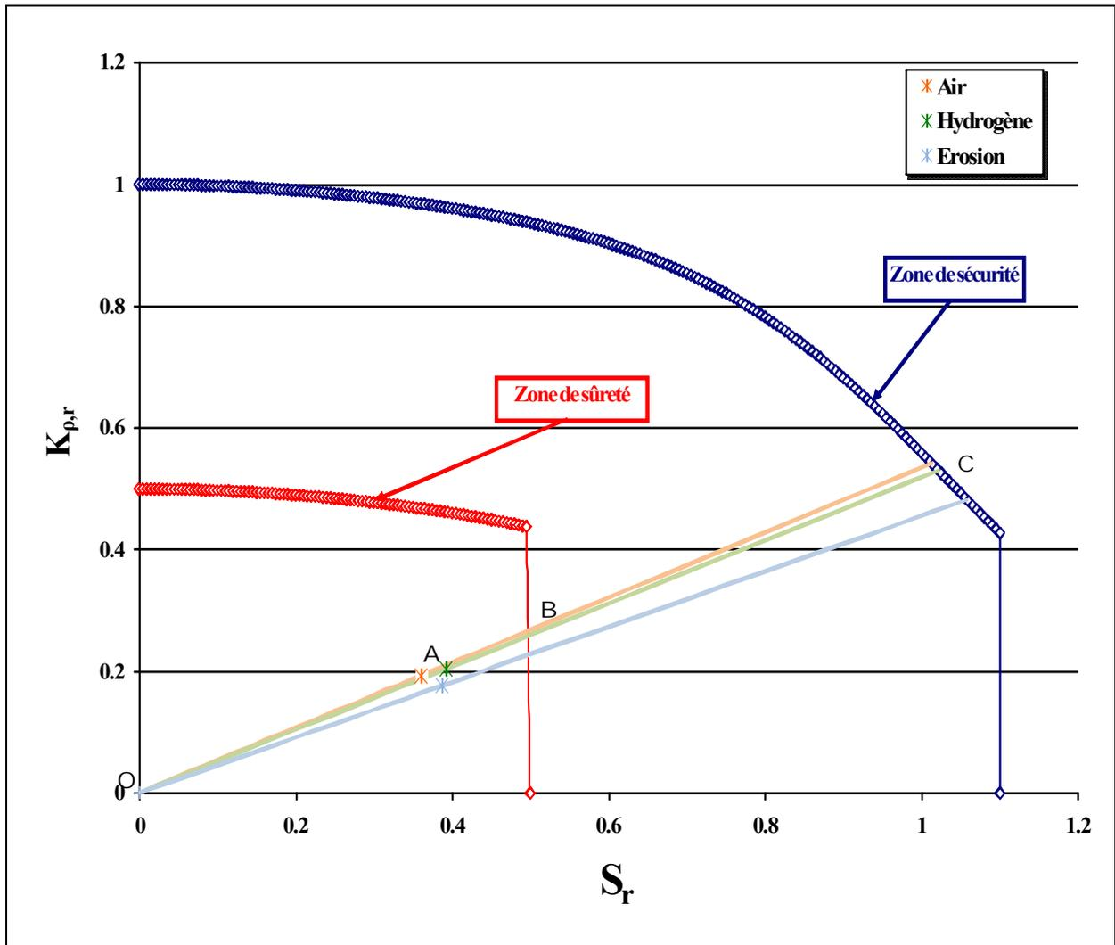
Figure V-2 : Evolution du point de fonctionnement.
