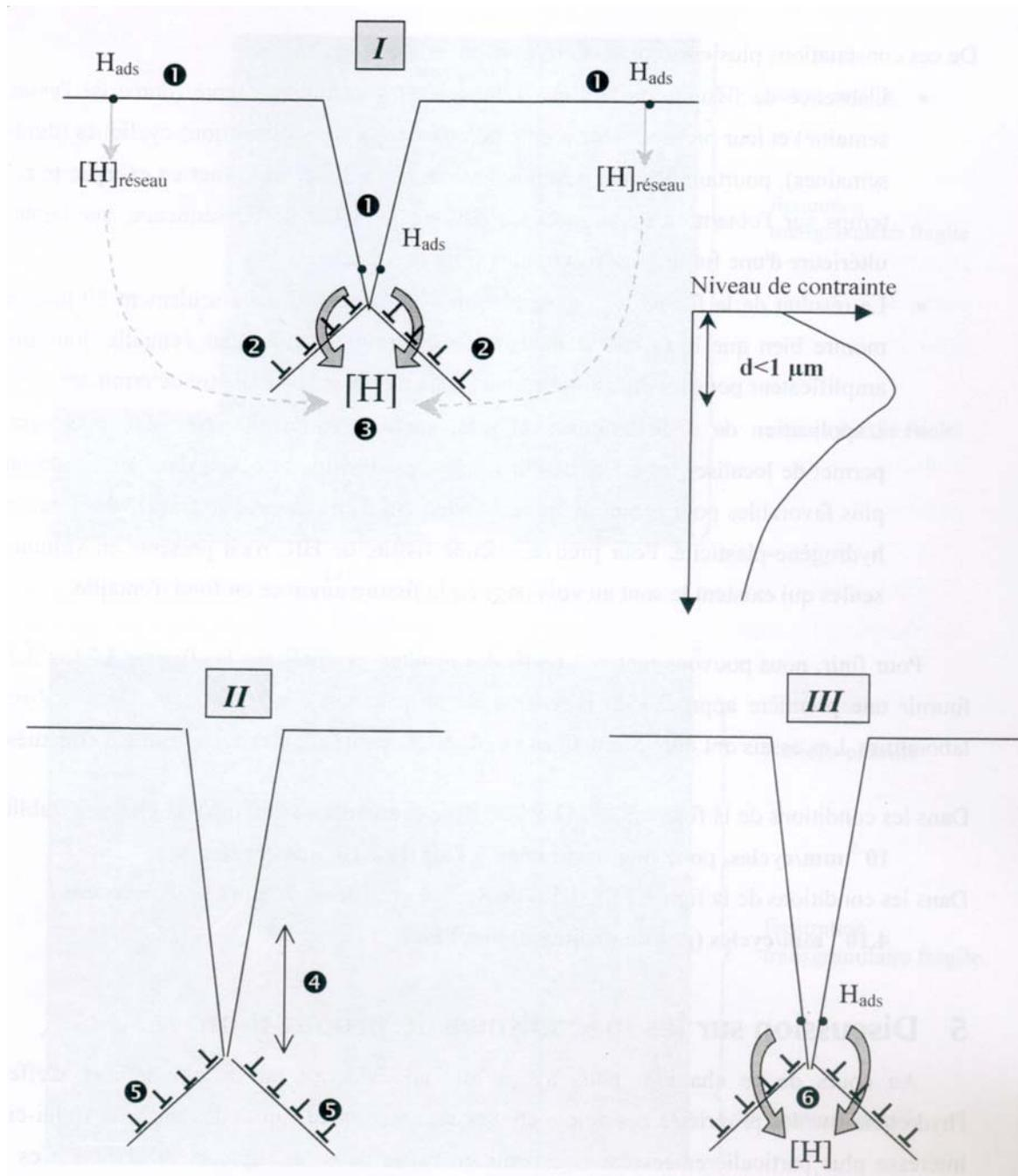
Figure I-53 : Mécanisme de propagation d'une fissure par clivage [110].
