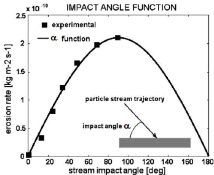
Figure I-8 : Erosion en fonction de l'angle d'impact [16].
