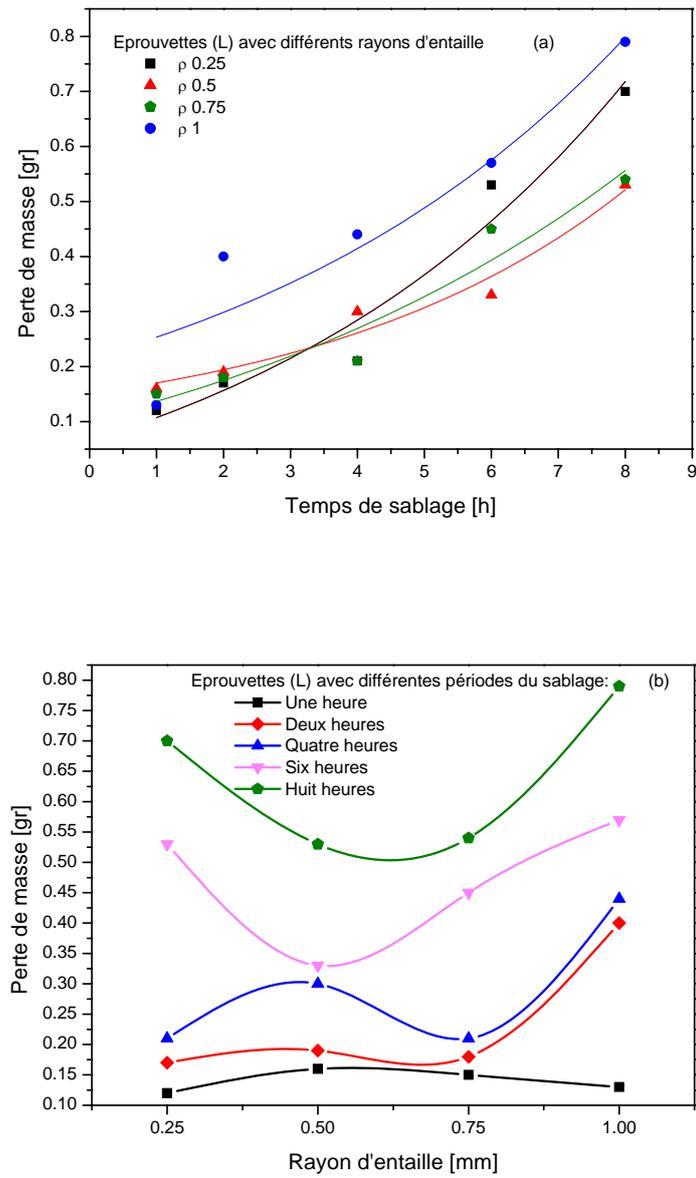
Figure II-18 : Evaluation de la perte de masse dans le sens longitudinal en fonction de :
