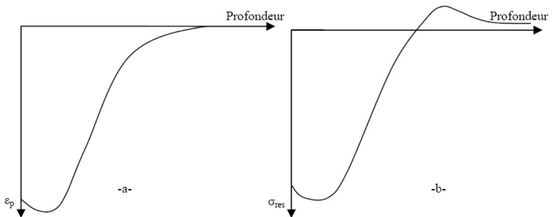
Figure I-33 : Représentation schématique : a) Profil de déformation plastique et b) Distribution de contraintes résiduelles associées en profondeur [57].
