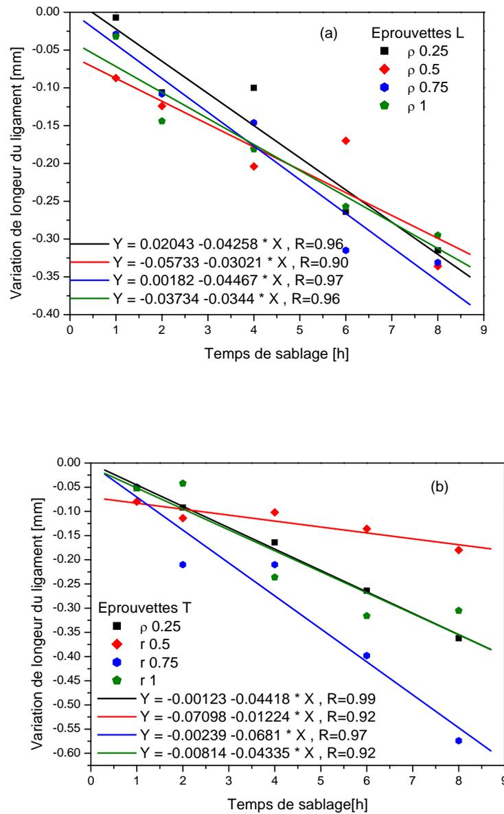
Figure II-31 : Variation de longueur du ligament pendant le sablage dans les deux sens :
