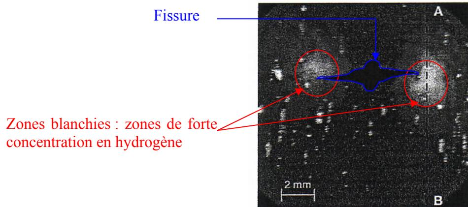
Figure I-56 : Image obtenue par microscopie photoélectrochimique de la zone proche d'une fissure (acier X46 chargé en H<sub>2</sub>) [93, 112].
