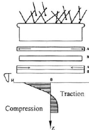
Figure I-32 : Principe de création de contraintes résiduelles par impact de particules solides [57].
