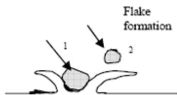
Figure I-5 : Déformation plastique [10].
