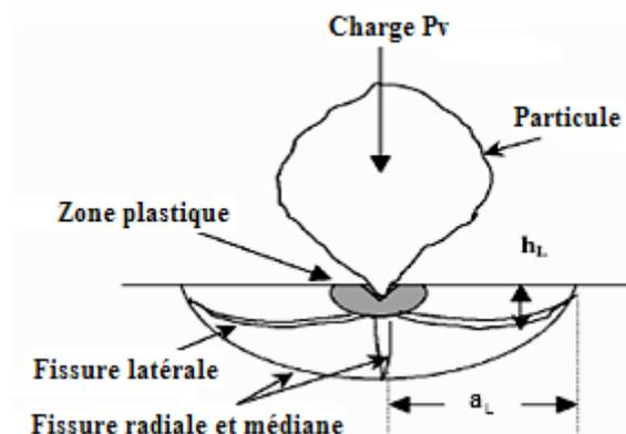
Figure I-1 : Fissures générées par impact de particules [5].
