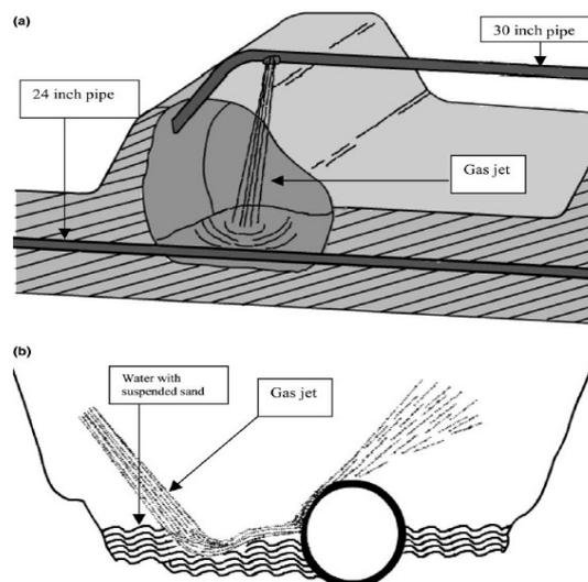
Figure I-22 : Mécanisme d'érosion du tuyau A (610 mm) [52].
