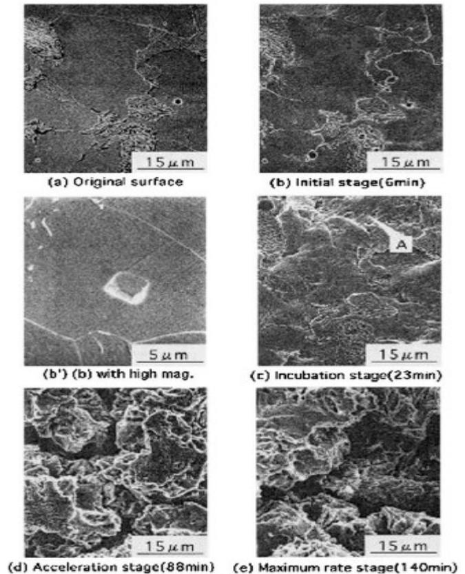
Figure I-24 : Surfaces érodées de l'acier S15C [12].
