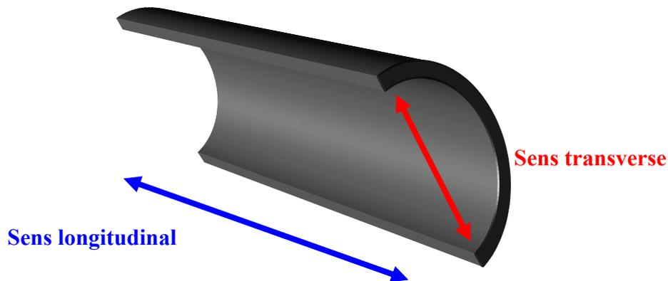
Figure II-1 : Sens longitudinal et transverse du tube.
