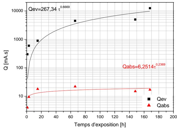
Figure II-40 : Quantité d'hydrogène créée et absorbée par l'acier API 5L X52.
