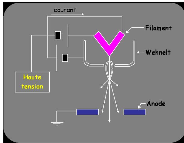
Figure IV-2 : Schéma d'un canon à électrons
