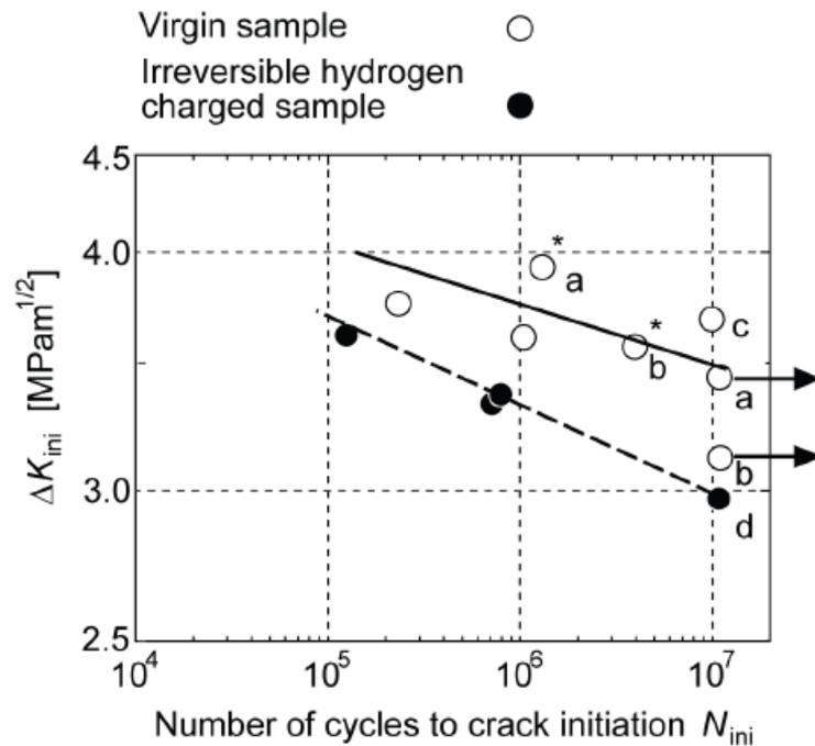
Figure I-51 : Influence de l'hydrogène sur le nombre de cycles d'initiation d'une fissure à partir d'une inclusion interne, La remarque \* indique que la fissure a été initiée, pour la 1<sup>ère</sup> fois, au niveau des contraintes élevées [104].
