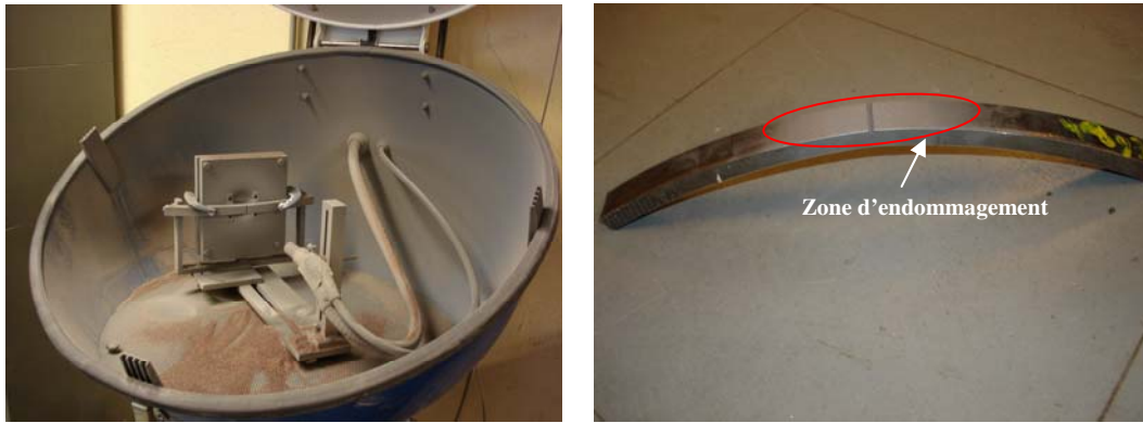
Figure III-14 : Mode de sablage d'une éprouvette 'tuile romaine'.
