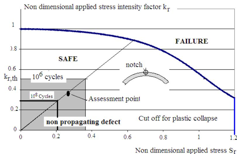
Figure V-1 : Diagramme Intégrité Rupture classique avec des conditions pour un défaut non propagé.
