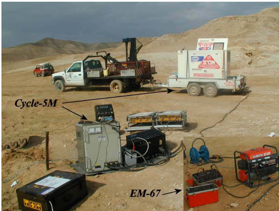
Figure 1.9 : Système de TDEM utilisé par Levi et al. [36]
