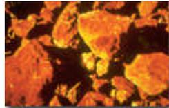
Découvert en 1831 par Pierre Berthier aux Baux de Provence, le minerai d'aluminium prendra le nom de Bauxite. Composé de 40 à 60 % d'oxydes d'aluminium hydratés, mélangés à de la silice et de l'oxyde de fer lui conférant une couleur rouge orangée intense, la bauxite doit subir plusieurs transformations avant de libérer le métal recherché.
