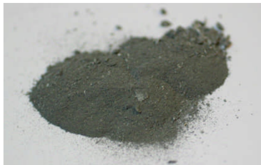
Figure 74. Prélèvement d'un échantillon de crasses sèches.
