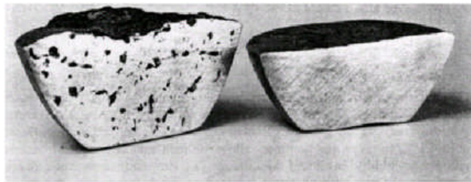
Figure 3. Effet de l'hydrogène dissous. A gauche un métal non dégazé, à droite un métal dégazé [4].
