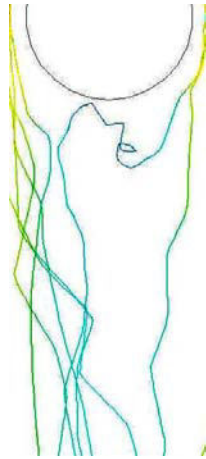
Figure 53. Trajectoires de particules dans le sillage d'une bulle. Simulation réalisée avec Fluent TM pour Re_b=10^4 .
