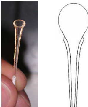
Figure 48. Forme des capillaires utilisés et représentation schématique de la morphologie des bulles.
