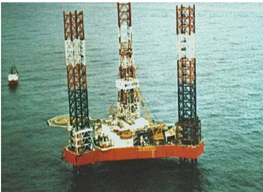
*Figure 1-1 : Plateforme de forage CFEM T 2005 autoélevatrice*
