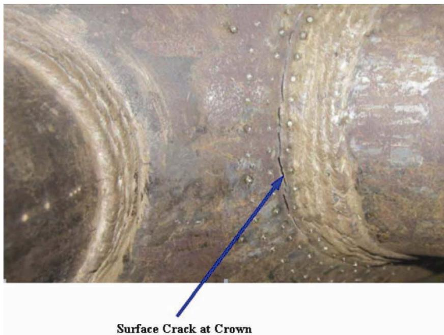
*Figure 5-13: Fissure près du point d'arçon d'une jonction K*
