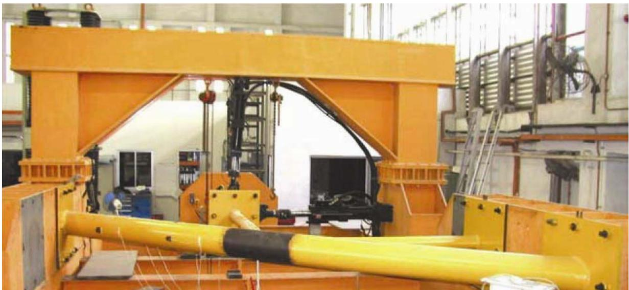
Figure 5-5 : Vue générale du montage d'essai pour une jonction K
