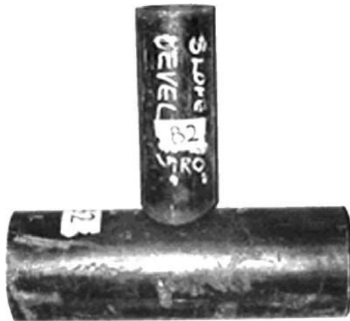
Figure 3-9 : Usinage d'une extrémité d'entretoise prenant en compte la circularité du manchon [3-14].
