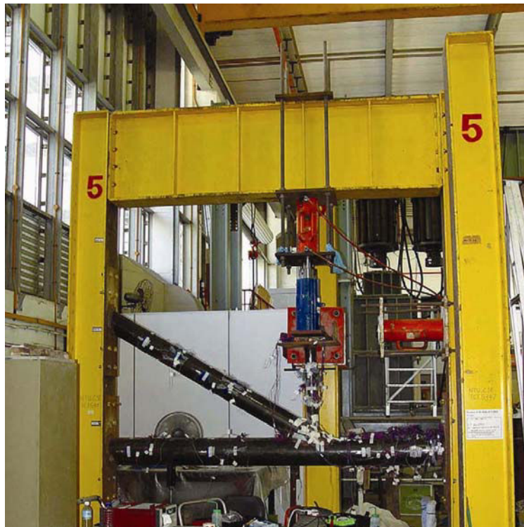
Figure 5-6 : Vue générale du montage d'essai des jonctions TY
