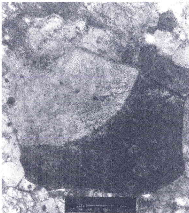
Figure V.3-4 : Sous grain de faible désorientation, suggérant l'activation d'un mécanisme de restauration dans un gros grain de l'échantillon composite.
