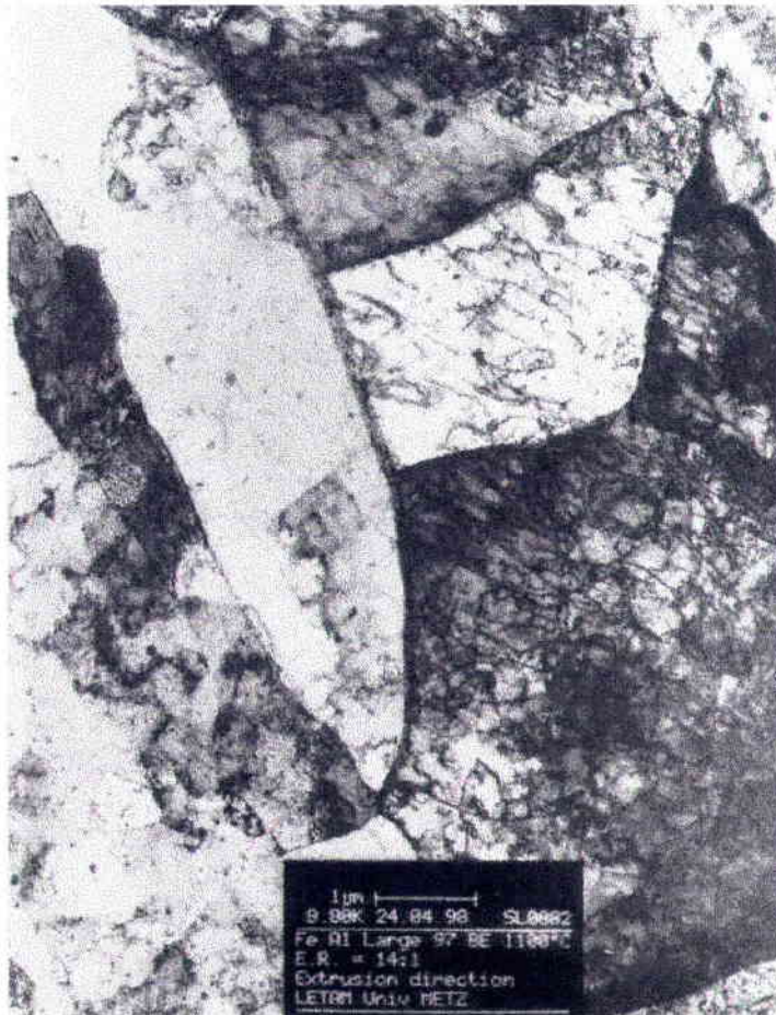
Figure III.1-12 : Be 1100 direction d'extrusion.
