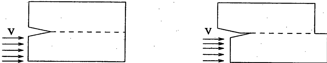
Figure 1.12. Géométrie de l'éprouvette et configuration du test d'impact. La plaque entaillée subit l'impact du projectile sur sa demi-hauteur inférieure. D'après Gioia et Ortiz (1996).
