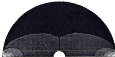
d) : Au bout de 16 micro secondes, l'état des contraintes s'homogénéise dans l'éprouvette. L'équilibre quasi statique est atteint. L'éprouvette rompra quelques instants plus tard
