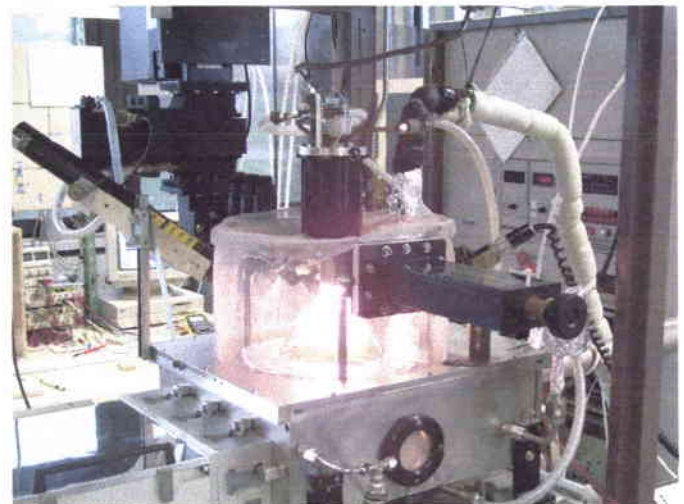
Figure II.2: (a) Schéma synoptique du réacteur de dépôt avec porte-substrat chauffant et (b) photo de l'enceinte de dépôt.
