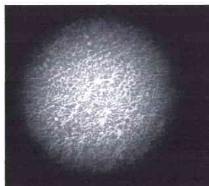
(2) ils se forment des micros bulles sous la surface
