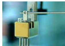
FIG. 2.9: Intervention manuelle pour ajuster le nombre des outils de dépôt sur les têtes d'impression (Image TeleChem).
