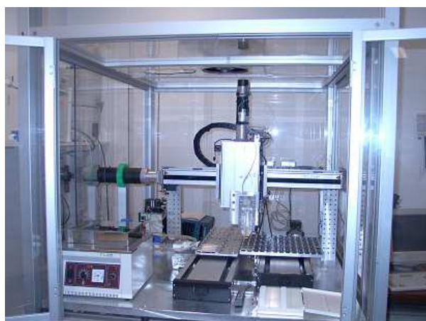
FIG. 1.21: Robot micropipeteur développé en partenariat avec l'IGBMC
