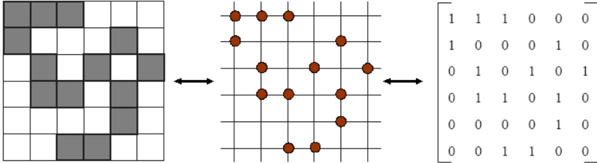
FIG. 3.5 – L'image binaire et la matrice binaire équivalente
