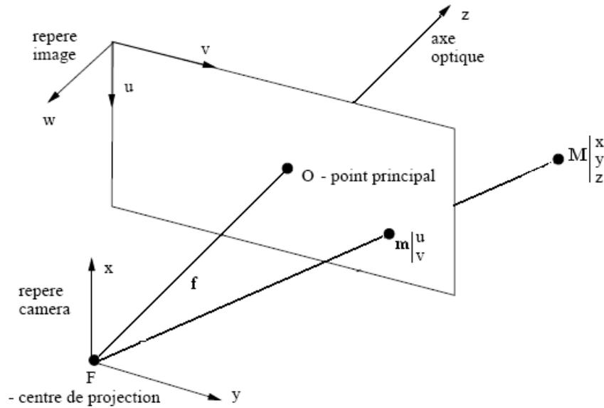
FIG. 5.1 – Le modèle géométrique d'une caméra.
