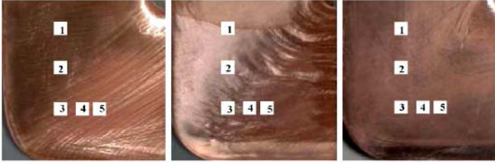
Figure I.20: Aspect macroscopique dans le plan DT des surfaces attaquées pour chaque groupe d'échantillons [Miyamoto05].
