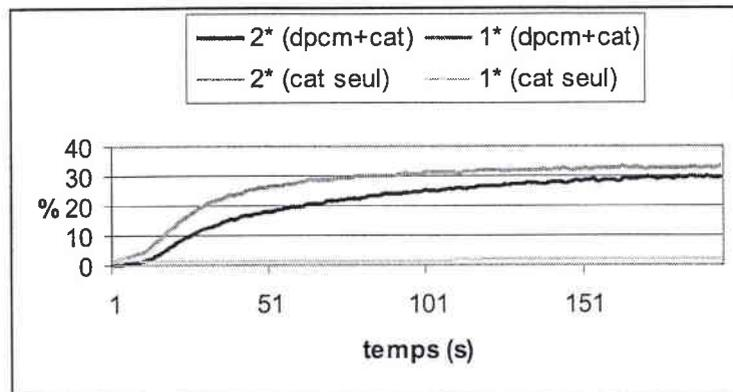
FIG. 5.52 – Mise en évidence du caractère négligeable de la conjugaison autopompée devant le DPCM pour  $d = 0 \mu\text{m}$ , soit à l'optimum avec un faisceau large et un faisceau fin dans le cristal non dopé
