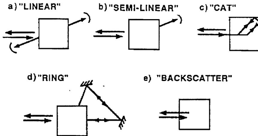
FIG. 2.7 – Différentes configurations de miroirs à conjugaison de phase autopompée présentées par Günter et Huignard [4] en 1988
