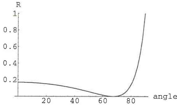
FIG. 5.2 – Evolution du rapport de l'intensité lumineuse réfléchi par rapport à celle incidente calculée en fonction de l'angle d'incidence en degrés pour un faisceau passant de l'air dans le cristal de  $BaTiO_3$
