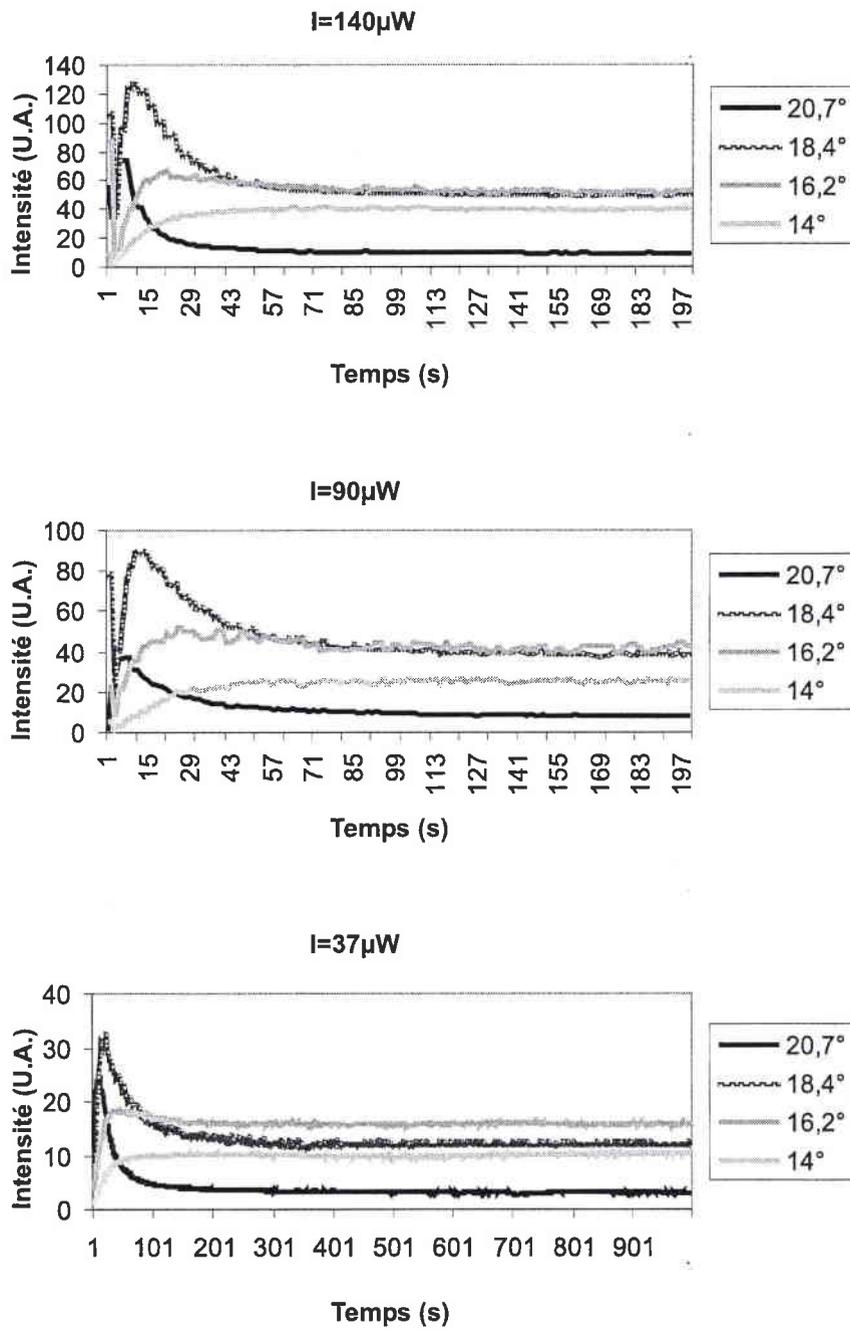
FIG. 4.23 – Evolution du fanning dans le cristal non dopé pour un angle d'incidence de  $23^\circ$  dans les directions principales prévues par le modèle développé en 4.5.1 pour diverses puissances incidentes.
