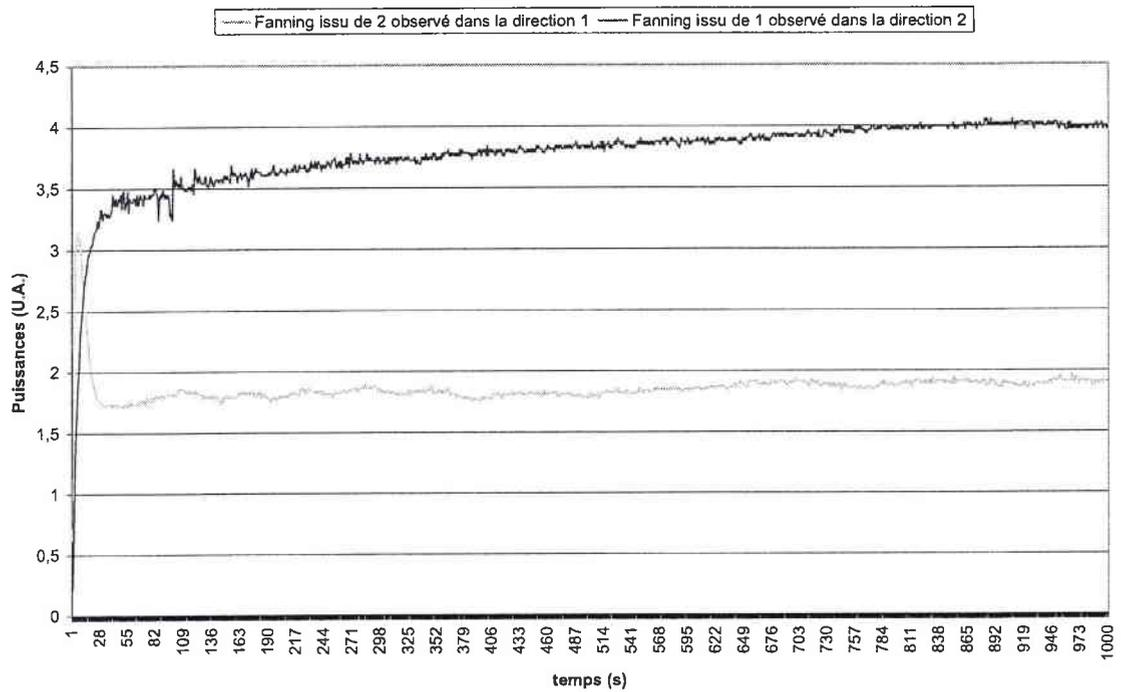
FIG. 5.27 - Evolution temporelle des intensités diffractées par le cristal dans les directions de conjugaison
