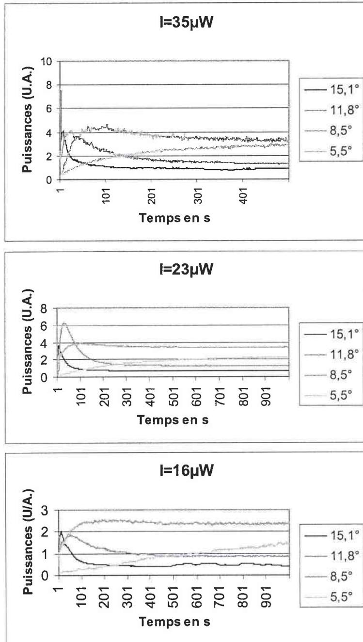
FIG. 4.25 – Evolution du fanning dans le cristal dopé pour un angle d'incidence de  $18.6^\circ$  dans les directions principales prévues par le modèle développé en 4.5.1 pour diverses puissances incidentes (suite).
