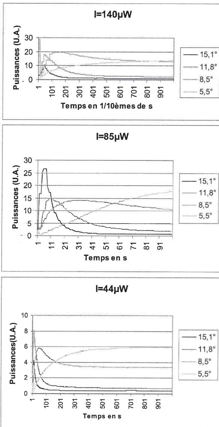
FIG. 4.24 – Evolution du fanning dans le cristal dopé pour un angle d'incidence de  $18,6^\circ$  dans les directions principales prévues par le modèle développé en 4.5.1 pour diverses puissances incidentes.
