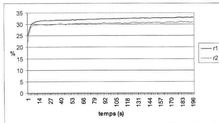
FIG. 5.9 – Evolution temporelle des rendements du DPCM dans le cristal non dopé avec deux faisceaux fins pour  $d = 0 \mu\text{m}$
