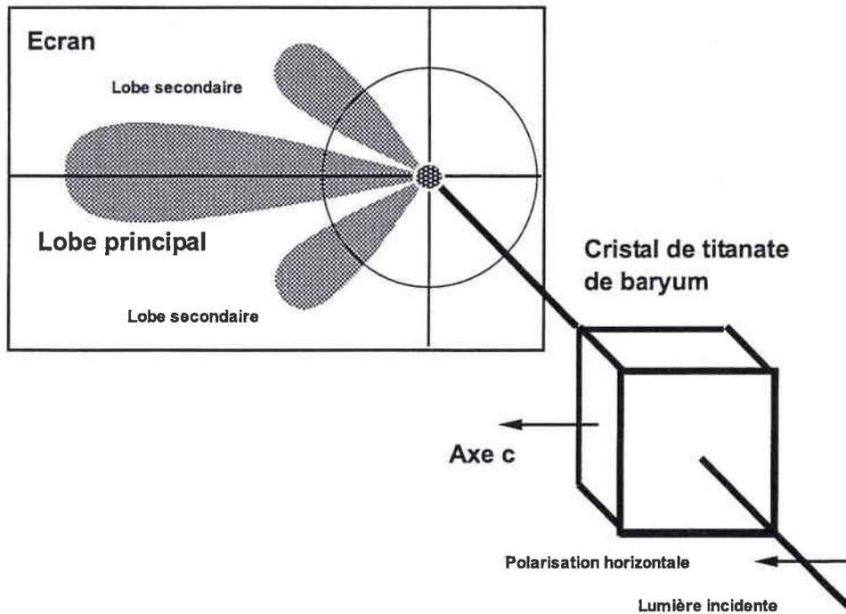
FIG. 4.2 – *Figure de fanning pour un cristal de BaTiO<sub>3</sub>*
