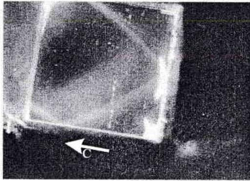
FIG. 3.25 – Photo prise en vue de dessus du cristal non dopé en configuration "fish head"
