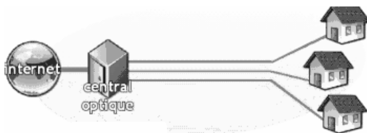
Figure 1.3 : FTTH point à point passif
