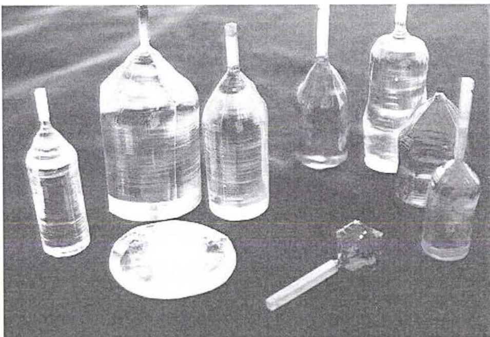
FIG. 1.4: Cristaux massifs de niobate de lithium purs et dopés (K. Polgar)
