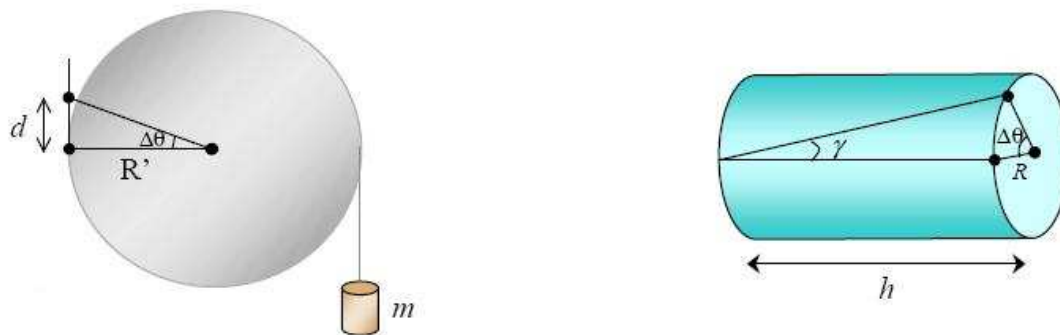
Figure III.12. Relation entre le déplacement tangentiel d et le cisaillement \gamma .
