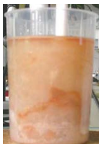
Figure 17 : lavage de \text{Fe}(\text{C}_{10})_2 in situ sous une couche protectrice d'huile alimentaire
