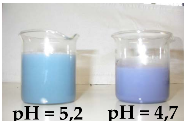
Figure 48 : variation de la couleur des précipités suivant le pH initial de la solution
