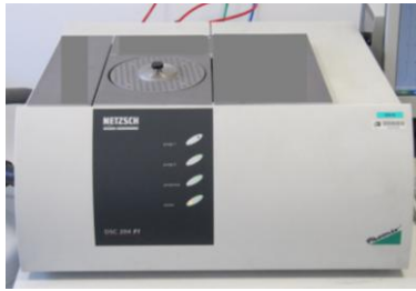
Fig. 2.17 : Calorimètre différentiel à balayage (DSC) 204 F1 Phoenix ® de Netzsch.
