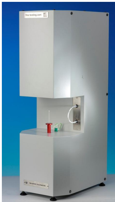
Fig. 2.21 : Microcalorimètre de combustion commercialisé par Fire Testing Technology.
