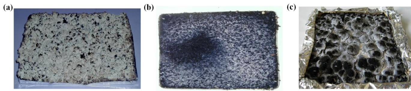
Fig. 3.18 : Clichés après les tests au cône calorimètre : PMMA-15% TiO_2 (a) [6], PMMA-15% Al_2O_3 (b) [38] et PMMA-15% AlOOH (c).
