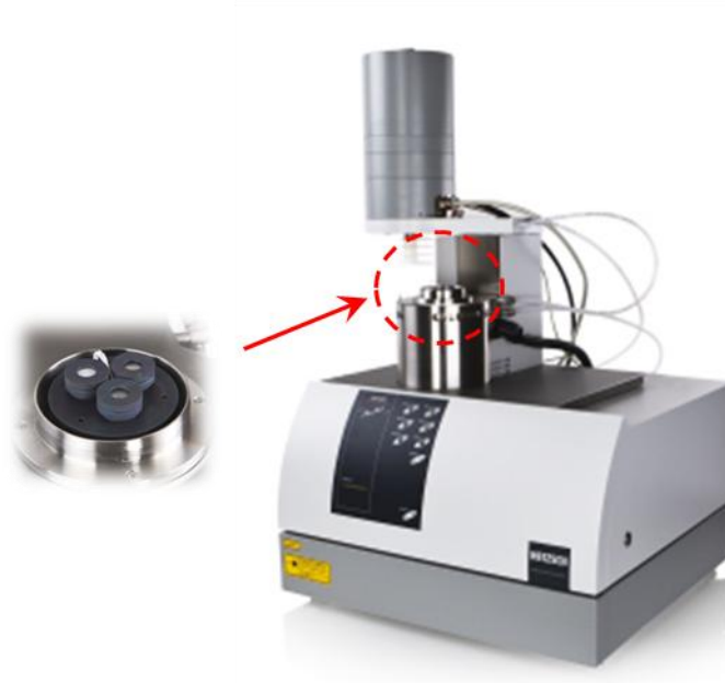
Fig. 2.18 : Appareil d'analyses par laser flash (LFA 457 Microflash™ de Netzsch).
