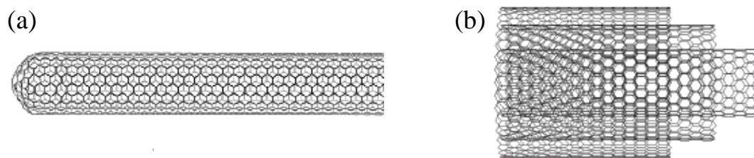
Fig. 1.27 : Structure de nanotubes de carbone monoparoi (SWNT) (a) et multiparoi (MWNT) (b) [91].
