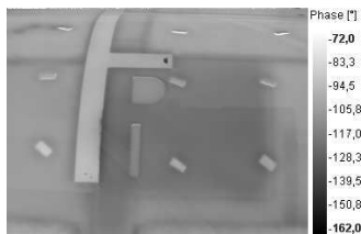
Figure 7.40: (a) La pièce étudiée de la Fig. 7.39 est divisée en cinq parties. Les images (b-f) montrent les cinq images de phase obtenues avec la thermographie lockin à une fréquence de 0.01 Hz.
