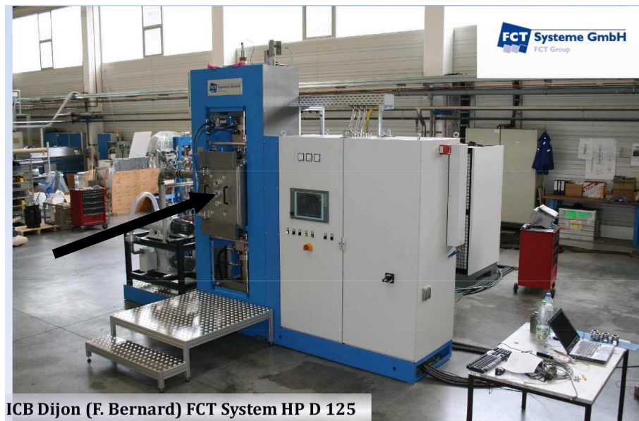
FIG. 3.1 – Procédé « Frittage Flash » (FCT Systeme GmbH, HP D 125) étudié et modélisé dans ce mémoire. Le système est localisé au laboratoire interdisciplinaire Carnot de Bourgogne (ICB), de l'Université de Bourgogne à Dijon.
