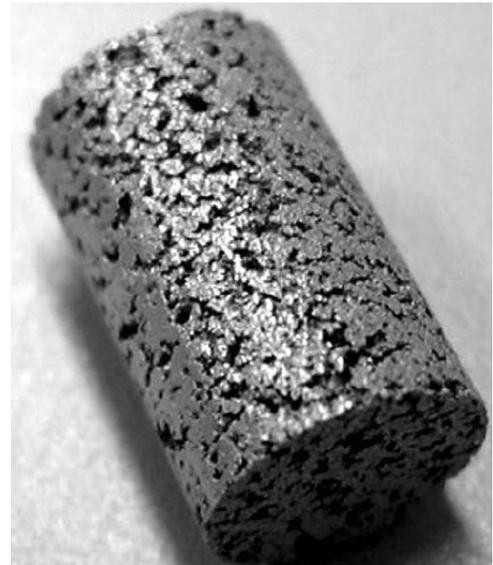
Figure II-14 : Exemple de pièce poreuse en titane découpée dans un dépôt réalisé par plasma spray<sup>38</sup>
