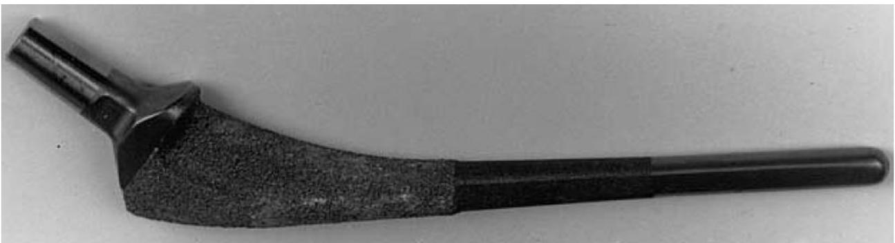
Figure II-13 : Vue d'une prothèse de hanche dont la partie proximale a été recouverte de titane poreux projeté par plasma spray<sup>37</sup>
