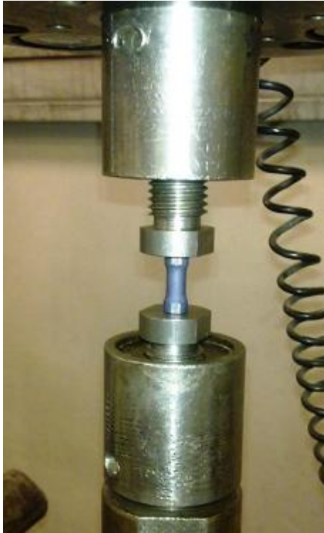
Figure III-36 : Éprouvette tubulaire fixée sur les mors d'une machine de fatigue grâce aux pièces d'adaptation
