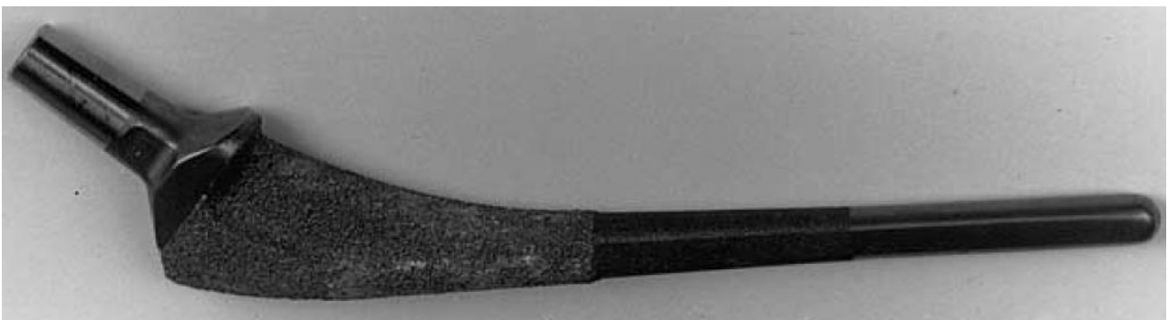
Figure II-13 : Vue d'une prothèse de hanche dont la partie proximale a été recouverte de titane poreux projeté par plasma spray 37
