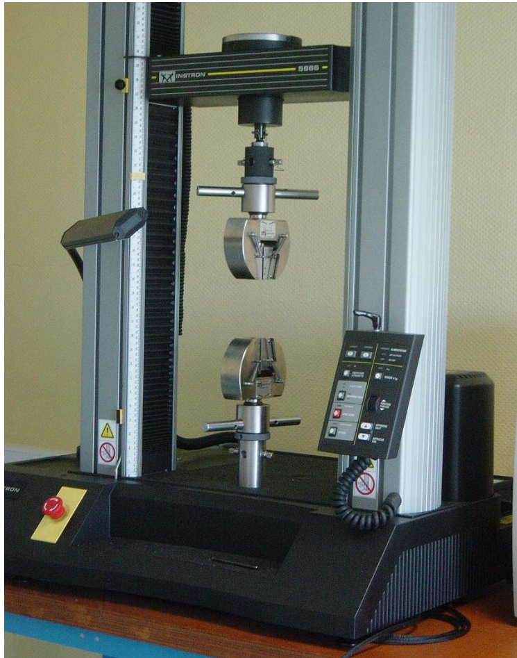
Figure II-23 : Vue de la machine de traction avec une éprouvette montée dans les mors
