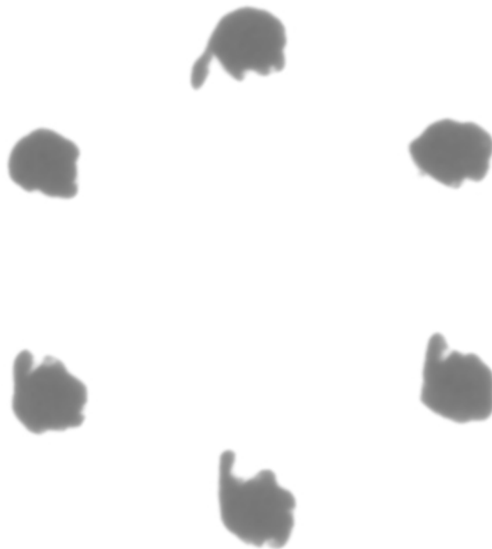
Figure III-31 : image d'une section d'une éprouvette à six branches provenant de l'analyse au tomographe
