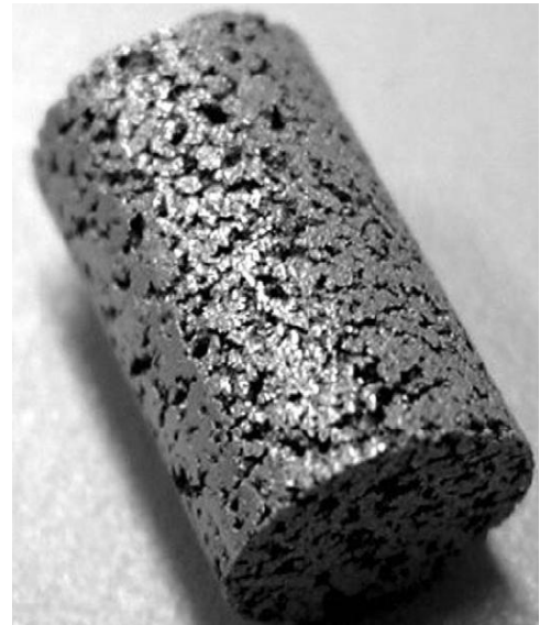
Figure II-14 : Exemple de pièce poreuse en titane découpée dans un dépôt réalisé par plasma spray 38
