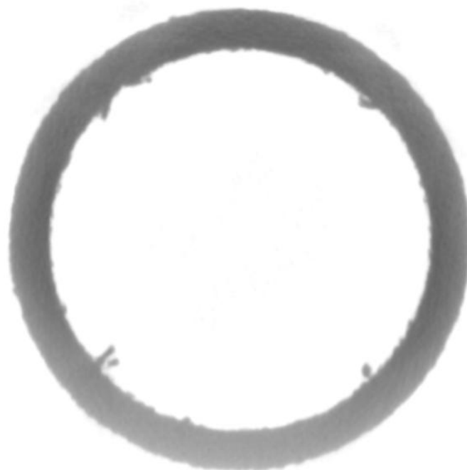
Figure III-35 : Image de la section utile d'une éprouvette tubulaire issue de la tomographie
