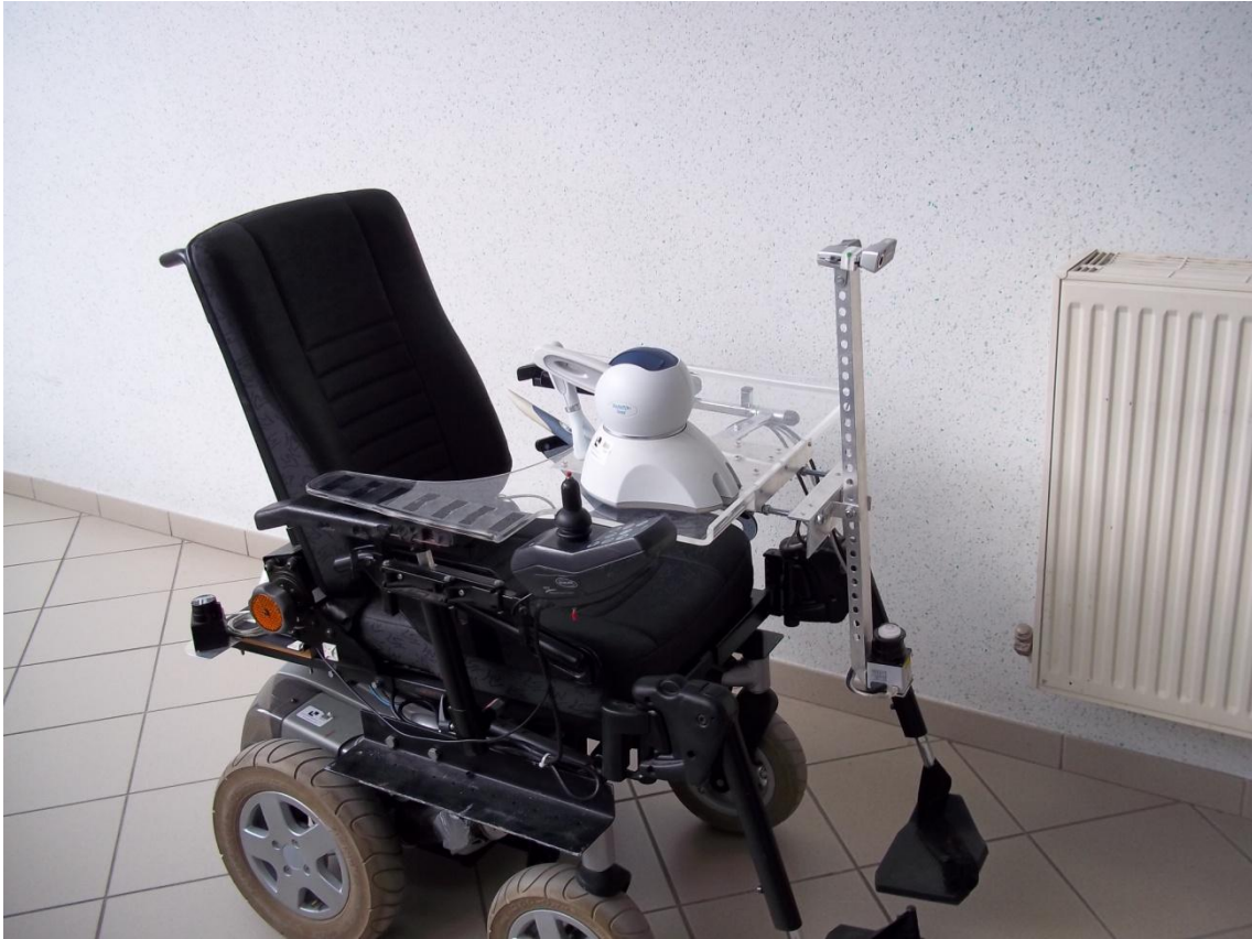
Figure 2.17: Fauteuil VAHM avec le PHANTOM Omni.
