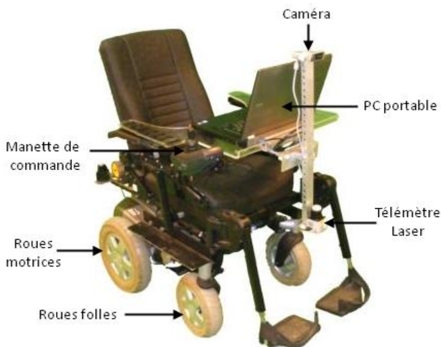
Figure 2.2: Fauteuil VAHM 3 instrumenté (100cmx70cm).
