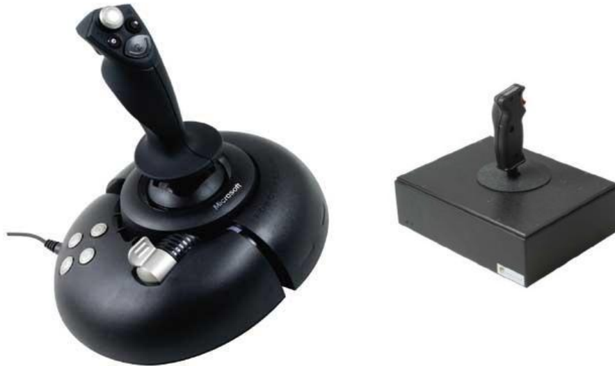
Figure 1.9: Joysticks à retour d'effort : (a) Microsoft SideWinder 2 (à gauche) - (b) Impulse Stick (à droite).
