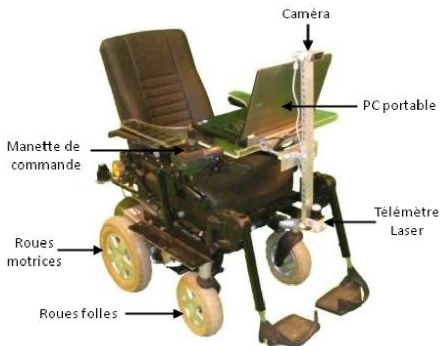
Figure 2.2: Fauteuil VAHM 3 instrumenté (100cmx70cm).
