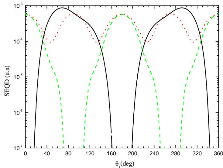
**Figure III.15 :** Variation de la SEQD de l'orbitale  $2a_1$  pour  $E_i = 1 \text{ keV}$ ,  $E_1 = E_2 = 10 \text{ eV}$  et  $\theta_a = 0^\circ$ . Les trois directions  $\theta_2 = -\theta_1 + 2\pi$ ,  $\theta_2 = \theta_1 + \pi$  et  $\theta_2 = -\theta_1 + \pi$  sont respectivement représentées par une ligne continue, une ligne pointillée et une ligne discontinue.
