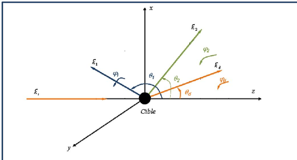
**Figure I.1 :** Représentation des différents vecteurs d'onde  $\vec{k}_i$ ,  $\vec{k}_d$ ,  $\vec{k}_1$ , et  $\vec{k}_2$  associés respectivement aux électrons incident, diffusé et éjectés.  $\theta_d$ ,  $\theta_1$ , et  $\theta_2$  sont les angles polaires de diffusion et d'éjection.  $\varphi_d$ ,  $\varphi_1$ , et  $\varphi_2$  sont les angles azimutaux de diffusion et d'éjection.
