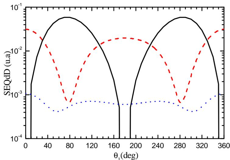
**Figure III.4 :** SEQdD de double ionisation de la molécule d'eau sans la contribution du noyau pour les conditions cinématiques  $E_i = 250$  eV,  $E_1 = E_2 = 5$  eV,  $\theta_d = 0^\circ$ ,  $\varphi_d = \varphi_1 = 0^\circ$  et pour  $(\alpha, \beta, \gamma) = (0^\circ, 180^\circ, 0^\circ)$ . Les trois orbitales  $1b_1$ ,  $3a_1$  et  $2a_1$  sont respectivement représentées par une ligne continue, une ligne discontinue et une ligne pointillée.
