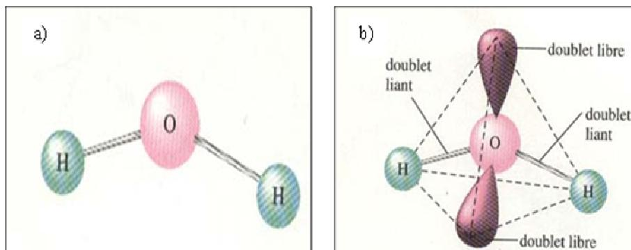
Figure II.1 : a) Structure moléculaire de la molécule d'eau, b) Disposition tétraédrique des quatre doublets d'électrons autour de l'oxygène.
