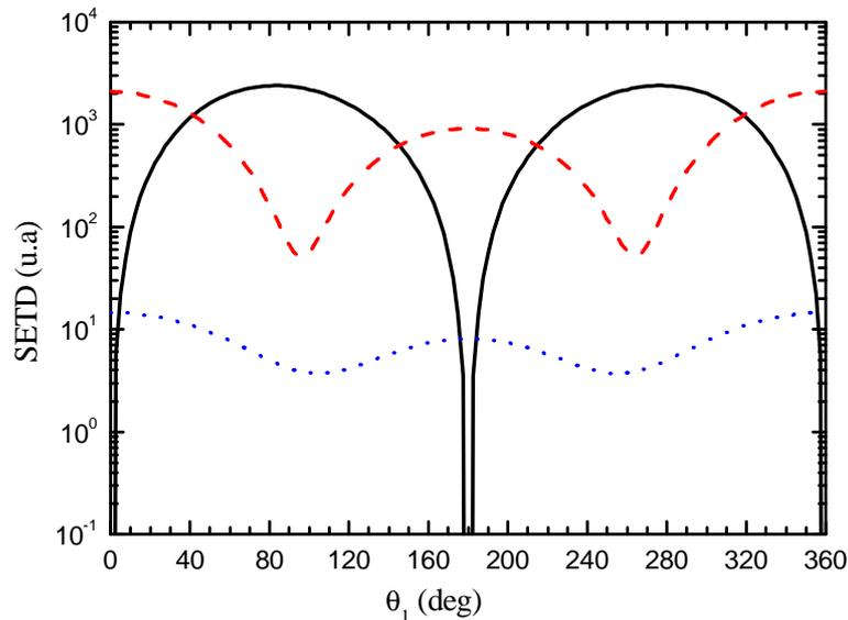
*Figure III.3 : SETD de simple ionisation de la molécule d'eau sans la contribution du noyau pour les conditions cinématiques  $E_i = 250$  eV,  $E_1 = 5$  eV,  $\theta_d = 0^\circ$ ,  $\varphi_d = \varphi_1 = 0^\circ$  et pour  $(\alpha, \beta, \gamma) = (0^\circ, 0^\circ, 0^\circ)$  [78]. Les trois orbitales  $1b_1$ ,  $3a_1$  et  $2a_1$  sont respectivement représentées par une ligne continue, une ligne discontinue et une ligne pointillée.*
