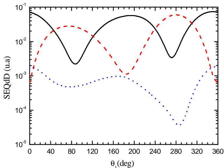
*Figure III.6 : SEQdD de double ionisation de la molécule d'eau sans la contribution du noyau pour les conditions cinématiques  $E_i = 250$  eV,  $E_1 = E_2 = 5$  eV,  $\theta_d = 0^\circ$ ,  $\varphi_d = \varphi_1 = 0^\circ$  et pour  $(\alpha, \beta, \gamma) = (0^\circ, 90^\circ, 0^\circ)$ . Les trois orbitales  $1b_1$ ,  $3a_1$  et  $2a_1$  sont respectivement représentées par une ligne continue, une ligne discontinue et une ligne pointillée.*
