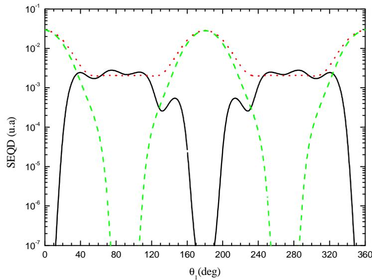
**Figure III.14 :** Variation de la SEQD de l'orbitale  $3a_1$  pour  $E_i = 1 \text{ keV}$ ,  $E_1 = E_2 = 10 \text{ eV}$  et  $\theta_a = 0^\circ$ . Les trois directions  $\theta_2 = -\theta_1 + 2\pi$ ,  $\theta_2 = \theta_1 + \pi$  et  $\theta_2 = -\theta_1 + \pi$  sont respectivement représentées par une ligne continue, une ligne pointillée et une ligne discontinue.
