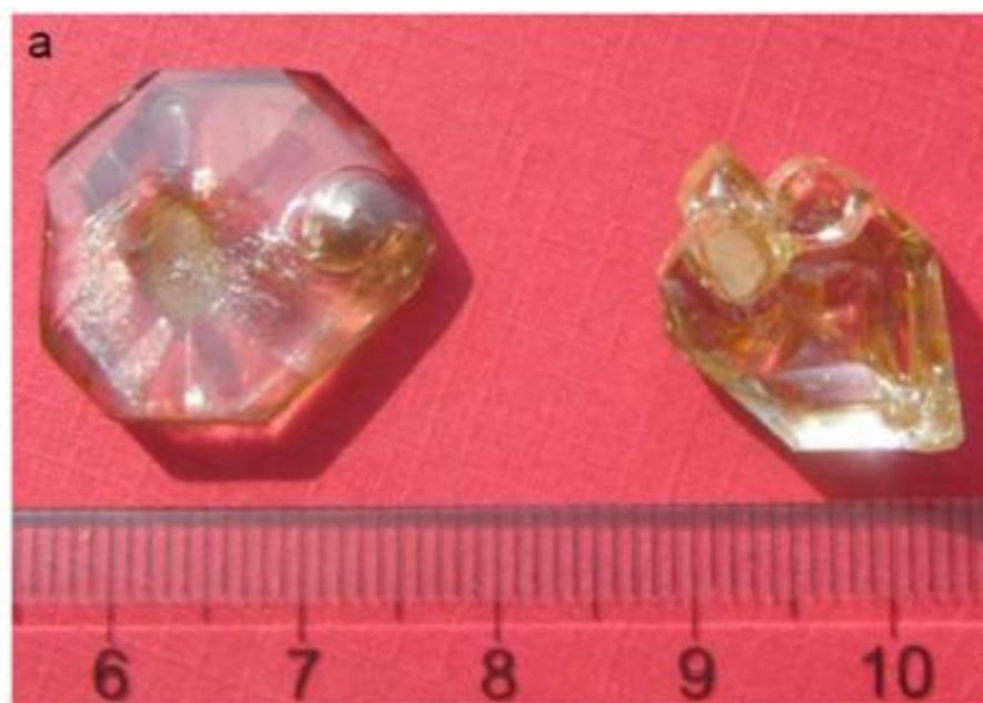
**Fig I.37:** Cristaux de BZBO élaborés par la technique TSSG [\[Li-2009\]](#)
