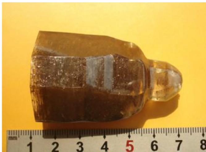
**Fig I.40:** Cristal de BZBO obtenu par la méthode de Czochralski [\[Li-2010a\]](#)
