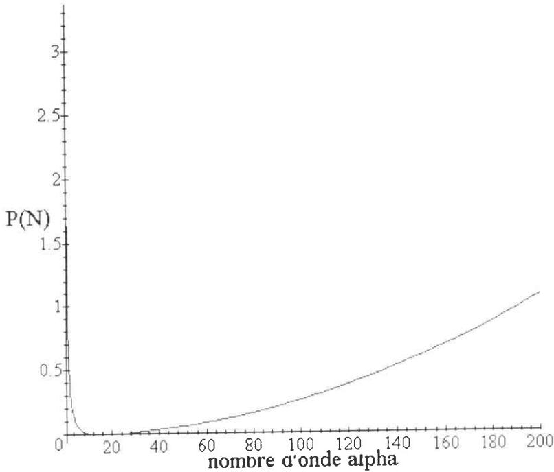
Figure III-17 : Exemple de courbe de stabilité neutre obtenue pour un état de matrice époxy correspondant à 79% de degré de conversion.
