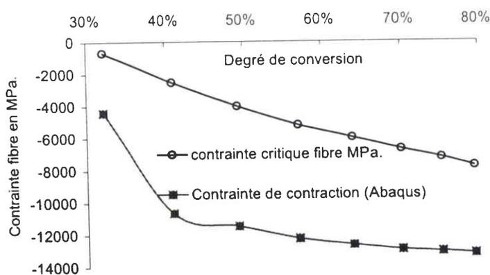
Figure IV-7 : Tracé comparatif de la contrainte critique de microflambage pour un pli de 0.2 mm d'épaisseur et de la contrainte réelle appliquée à la fibre par la contraction de la résine époxy lors de cette cuisson (cuisson isotherme à 120°C).
