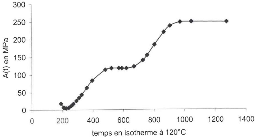
Figure III-37 : Evolution de la fonction  $A(t)$  au cours du temps pendant la cuisson en isotherme à 120°C.
