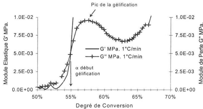
Figure II-23 : Evolution durant la réaction de la gélification des modules de cisaillement élastique  $G'$  et de perte  $G''$  de la résine époxy au cours d'une montée en température à  $1^{\circ}\text{C}/\text{min}$ . en fonction du degré de conversion.
