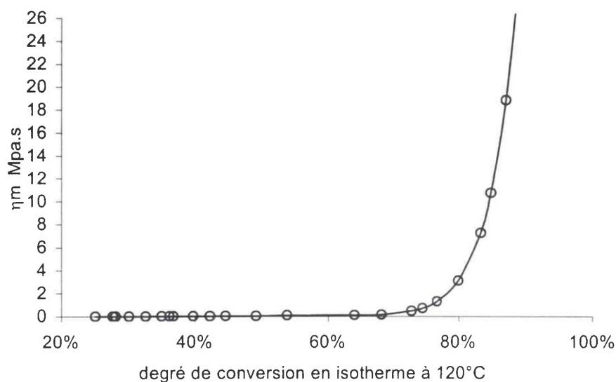
Figure III-32 : Evolution du module  $\eta_m$  de Zener au cours de la cuisson en isotherme à 120°C.
