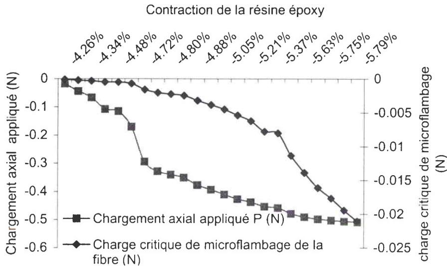
Figure III-23 : Comparaison entre la charge de compression appliquée à la fibre par la contraction chimique et la charge critique de microflambage en approche élastique pour la cuisson en isotherme à 120°C (approche plaque en contraintes planes).
