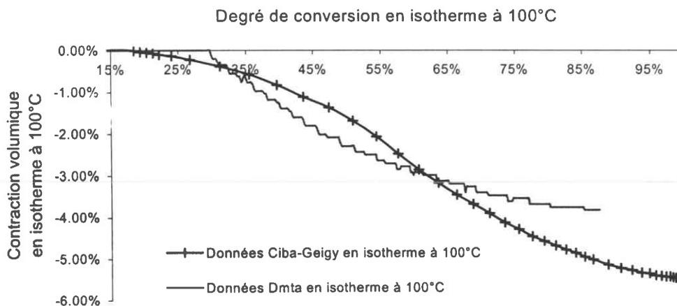
Figure II-34 : Comparaison des contractions volumiques en isotherme à 100°C fournies par la DMTA et par CIBA-GEIGY en fonction du degré de conversion.
