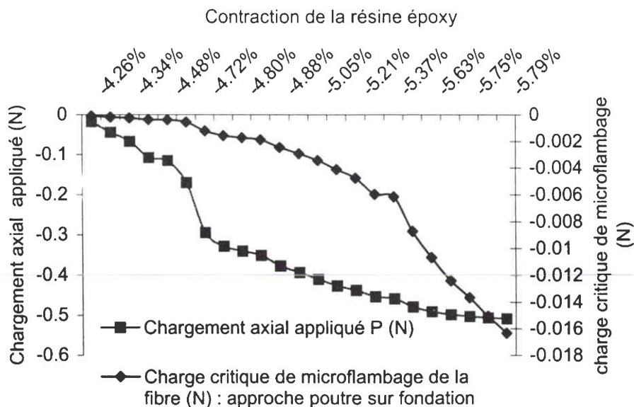
Figure III-24 : Comparaison entre la charge de compression appliquée à la fibre par la contraction chimique de thermodurcissement et la charge critique de microflambage en approche élastique pour la cuisson en isotherme à 120°C (approche poutre sur fondation).
