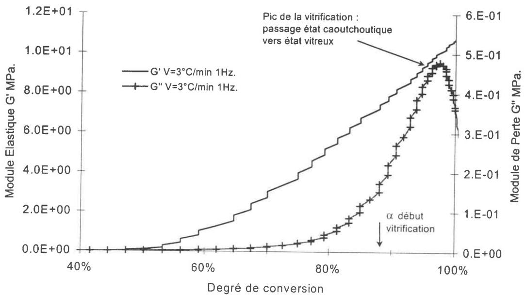
Figure II-27 : Evolution d'ensemble des modules de cisaillement élastique  $G'$  et de perte  $G''$  de la résine époxy au cours d'une montée en température à  $3^\circ\text{C}/\text{min}$ . puis maintenue à  $180^\circ\text{C}$ , en fonction du degré de conversion.
