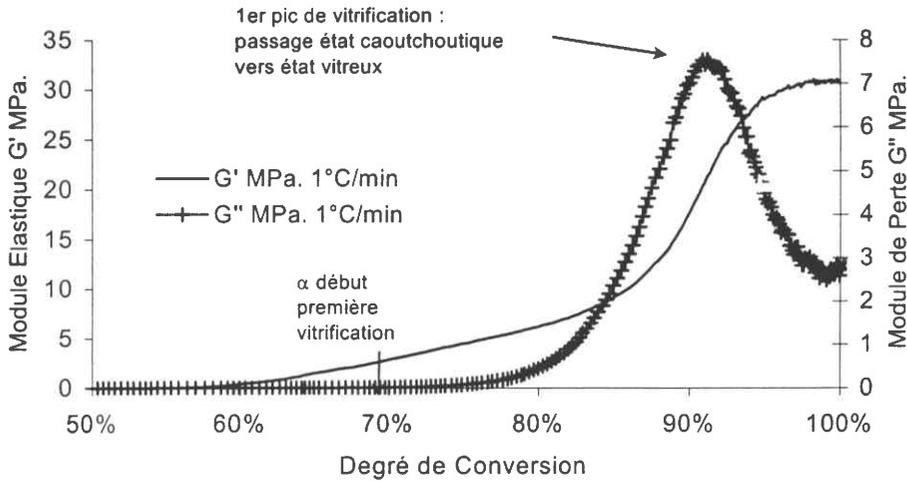
Figure II-21 : Evolution d'ensemble des modules de cisaillement élastique  $G'$  et de perte  $G''$  de la résine époxy au cours d'une montée en température à  $1^\circ\text{C}/\text{min}$ . en fonction du degré de conversion (fréquence 1Hz).
