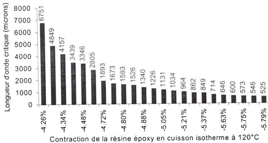
Figure III-25 : Longueur d'onde critique en fonction de la contraction de la résine pour la cuisson en isotherme à 120°C, modèle de BHALERAO (plaque élastique en contrainte plane).
