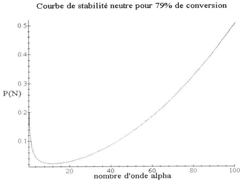
Figure III-22 : Exemple de courbe de stabilité neutre obtenue pour un état de matrice époxy correspondant à 79% de degré de conversion (approche plaque de BHALERAO).
