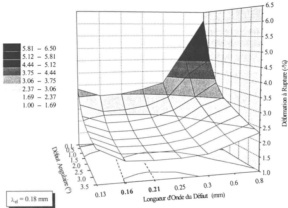
Figure 1 : Evolution des déformations à rupture du pli, en fonction du défaut angulaire initial obtenu avec différentes longueurs d'onde. Pli de 0.4 mm d'épaisseur situé à l'intérieur d'un stratifié carbone époxyde de type T300/914.
