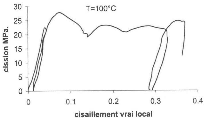
Figure I-7 : Courbe cission vraie-cisaillement vrai de la matrice époxy à 100°C.
