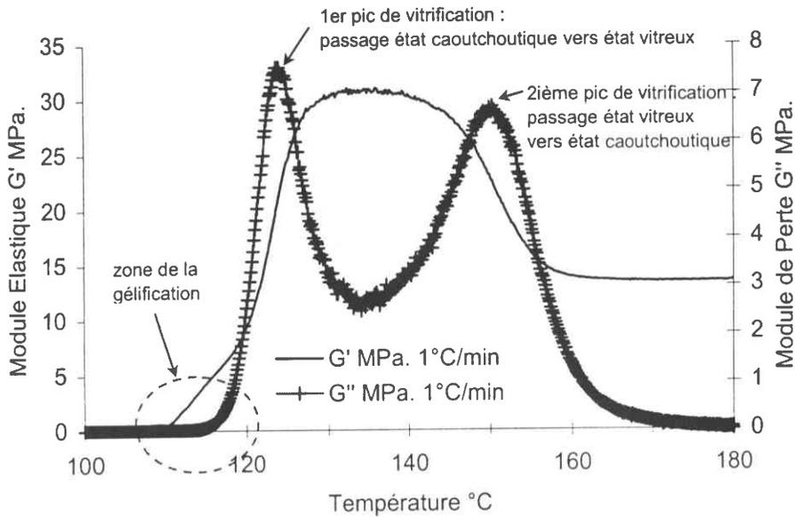
Figure II-18 : Evolution de modules de cisaillement élastique  $G'$  et de perte  $G''$  de la résine époxy au cours d'une montée en température à 1°C/min. (fréquence 1Hz).
