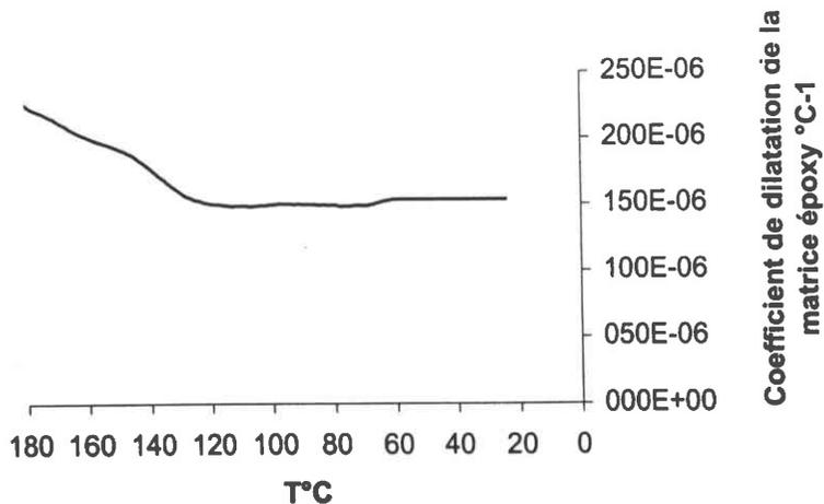
Figure I-14 : Evolution du coefficient de dilatation de la matrice époxy au cours de la phase finale de refroidissement.
