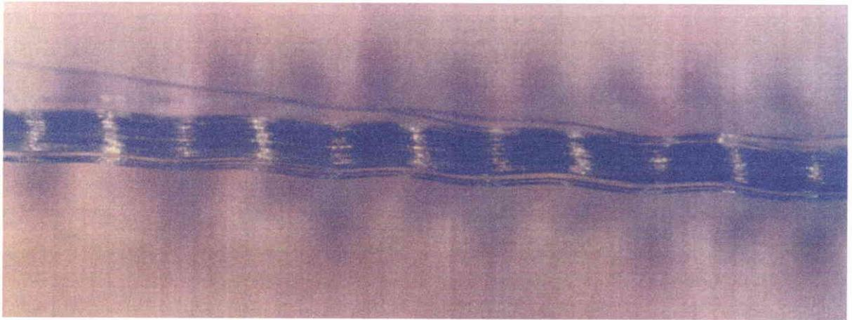
Figure IV-3 : Exemple de microflambage en phase observé sur une mèche de  $n$  fibres placées dans une éprouvette de matrice époxy (cuisson 2h à 100°C + 2h à 140°C) grossissement 200 fois ; la longueur d'onde observée est de l'ordre de 220 microns.
