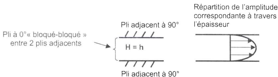
Figure IV-6 : Identification de l'épaisseur mésoscopique caractéristique  $H$  dans le cas d'un pli pris à l'intérieur du stratifié et description de la fonction d'amplitude correspondante  $V(y)$  à travers l'épaisseur.
