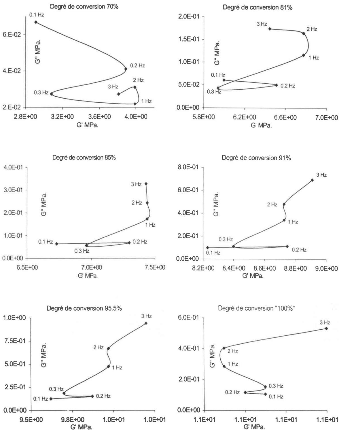
Figures II-46 : diagrammes de Cole-Cole C de la résine époxy LY 556 pour la cuisson durant la montée à  $3^{\circ}\text{C}/\text{min}$ .
