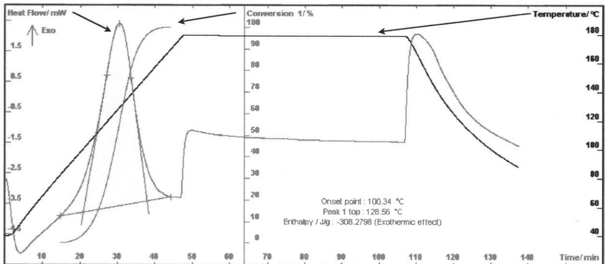
Figure II-2 : Analyse DSC de la cuisson de la résine époxy avec une montée en température de  $3^\circ\text{C}/\text{min}$ .
