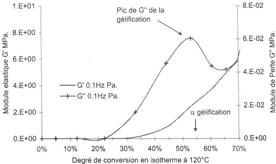
Figure II-31 : Evolution durant la phase de gélification des modules de cisaillement élastique  $G'$  et de perte  $G''$  de la résine époxy au cours de l'isotherme à 120°C en fonction du degré de conversion.
