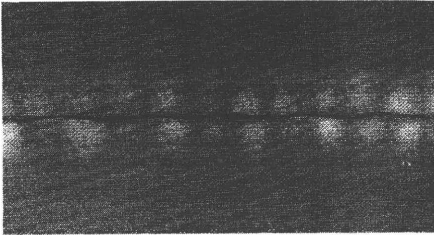
Figure 3 : Eprouvette monofilamentaire non sollicitée, sous lumière polarisée.
