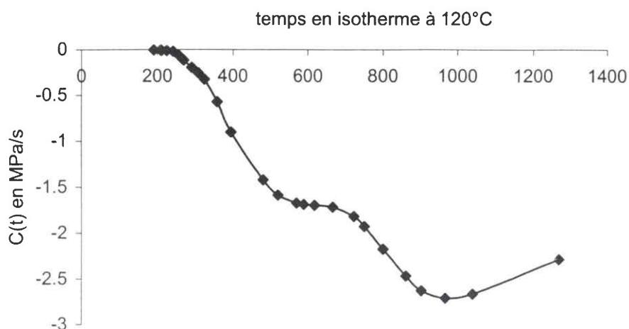
Figure III-39 : Evolution de la fonction  $C(t)$  au cours du temps pendant la cuisson en isotherme à  $120^{\circ}\text{C}$ .
