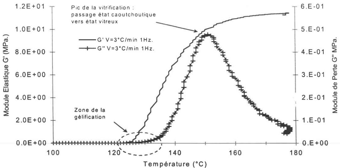
Figure II-24 : Evolution des modules de cisaillement élastique  $G'$  et de perte  $G''$  de la résine époxy au cours d'une montée en température à  $3^{\circ}\text{C}/\text{min}$ . puis maintenue à  $180^{\circ}\text{C}$ .
