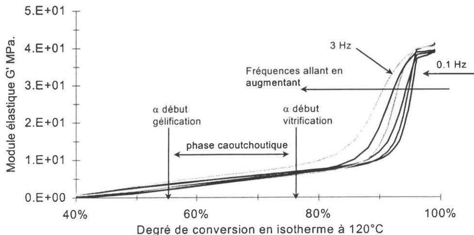
Figure II-40 : Evolution du module de cisaillement élastique  $G'$  en isotherme à  $120^{\circ}\text{C}$  en fonction du degré de conversion.
