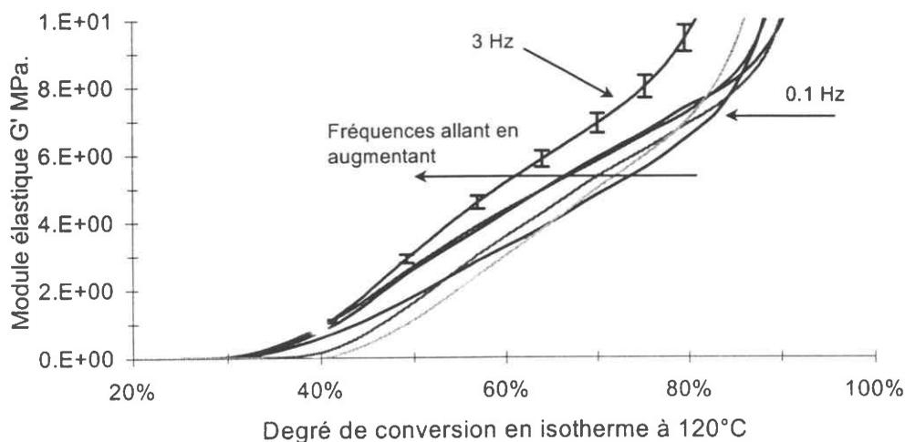
Figure II-41 : Evolution du module de cisaillement élastique  $G'$  en isotherme à 120°C en fonction du degré de conversion dans la zone de la gélification.
