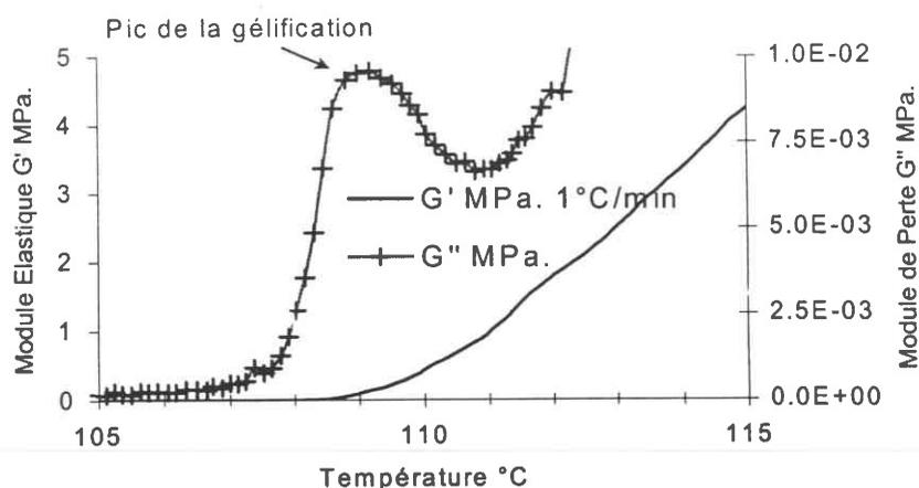
Figure II-20 : Evolution des modules de cisaillement élastique  $G'$  et de perte  $G''$  de la résine époxy au cours d'une montée en température à 1°C/min. durant la phase de gélification (fréquence 1Hz).
