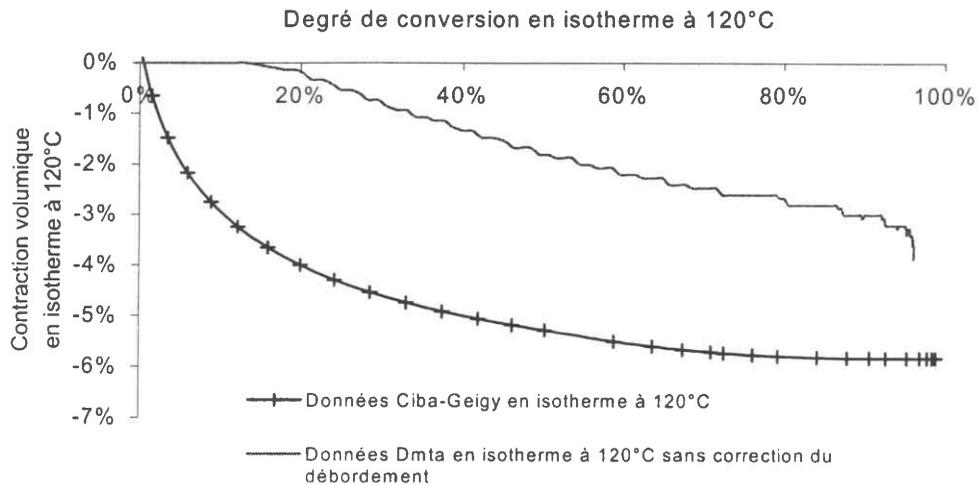
Figure II-36 : Comparaison des contractions volumiques en isotherme à 120°C fournies par la DMTA, sans correction du débordement, et par CIBA-GEIGY, en fonction du degré de conversion.
