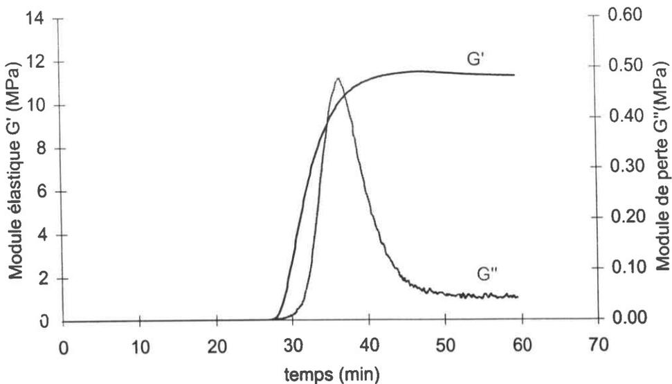
Figure II-3 : Evolution des modules de cisaillement élastique et visqueux de la résine au cours de son thermodurcissement pour une montée en température à  $3^{\circ}\text{C}/\text{min}$ , D.M.T.A. 1 Hz.
