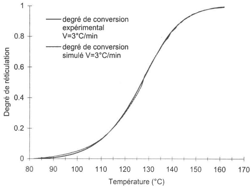
Figure II-14 : Confrontation entre le degré de conversion simulé et le degré de conversion expérimental pour une cuisson à 3°C/min.
