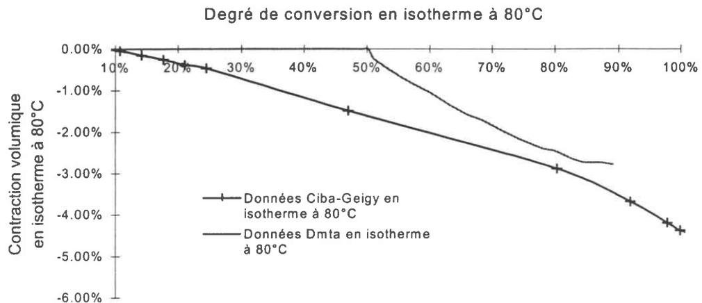
Figure II-33 : Comparaison des contractions volumiques en isotherme à 80°C fournies par la DMTA et par CIBA-GEIGY en fonction du degré de conversion.
