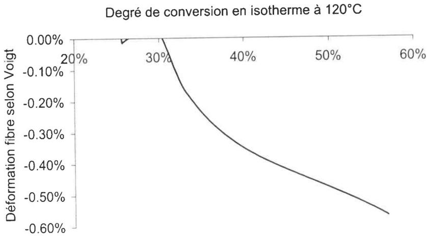
Figure III-40 : Evolution de la déformation appliquée à la fibre au cours de la cuisson en isotherme à 120°C, établie avec le modèle de Voigt.
