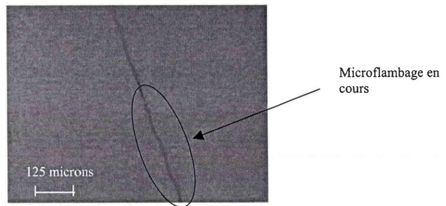
Figure III-5 : Microflambage de la fibre de carbone au sein de la matrice, 7 secondes après.
