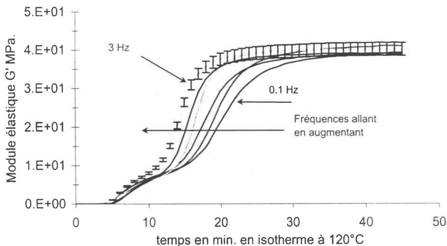
Figure II-39 : Evolution du module de cisaillement élastique  $G'$  au cours du temps (isotherme à 120°C).
