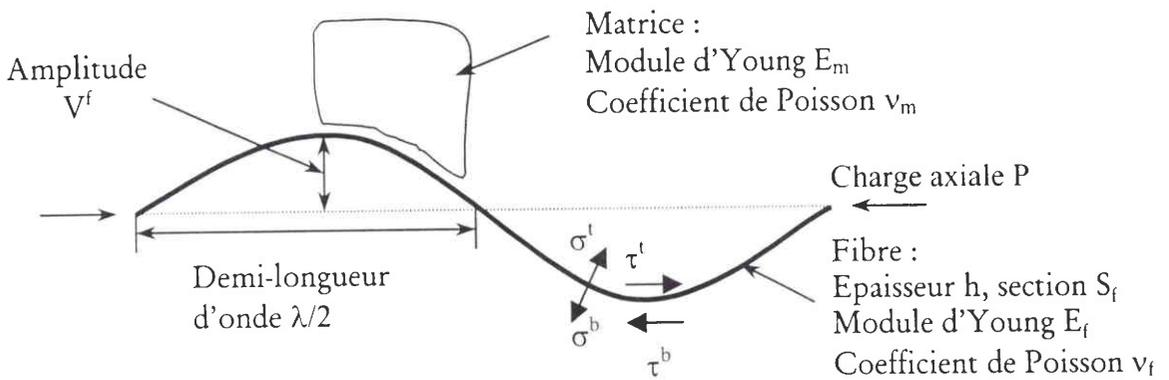
Figure III-21: Description de l'ondulation de microflambage au sein d'une matrice infinie élastique.
