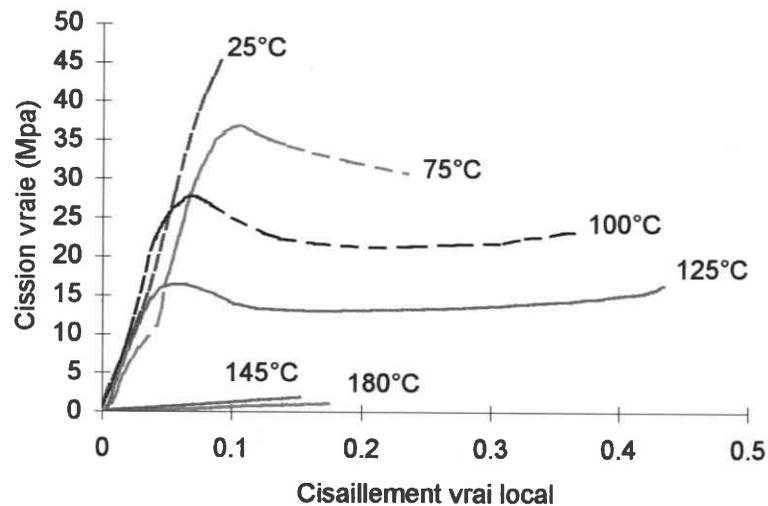
Figure I-4 : Cisssion fonction du cisaillement local de la matrice époxy en fonction de la température.
