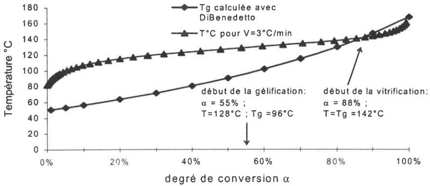
Figure II-25 : Evolution de la température de transition vitreuse et de la température de cuisson en fonction du degré de conversion  $\alpha$  de la résine époxy au cours d'une montée en température à  $3^\circ C/min$ .
