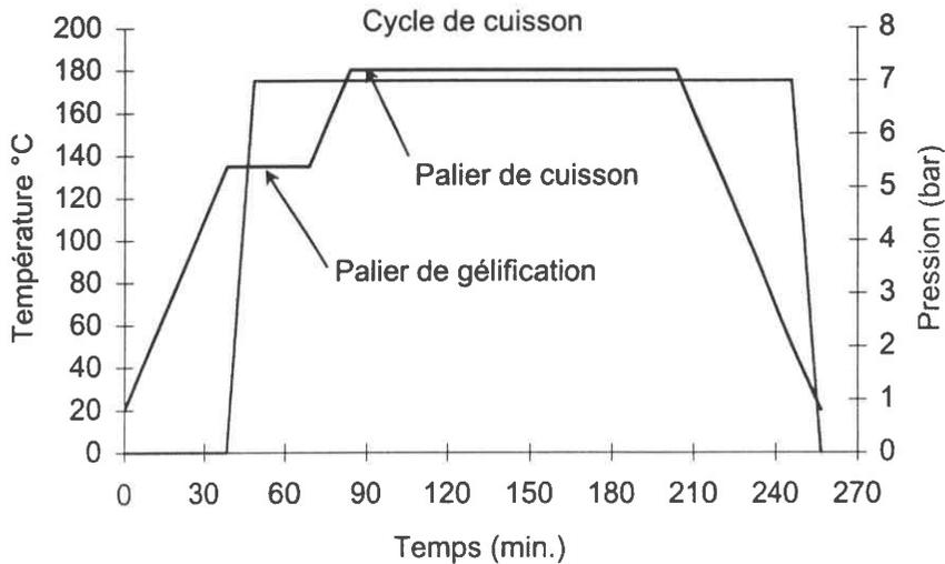
Figure 4 : Cycle de cuisson classique d'une résine époxy.
