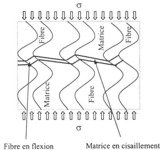
Figure I-2 : Mode de flambage en phase.
