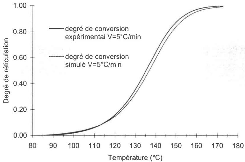
Figure II-15 : Confrontation entre le degré de conversion simulé et le degré de conversion expérimental pour une cuisson à 5°C/min.
