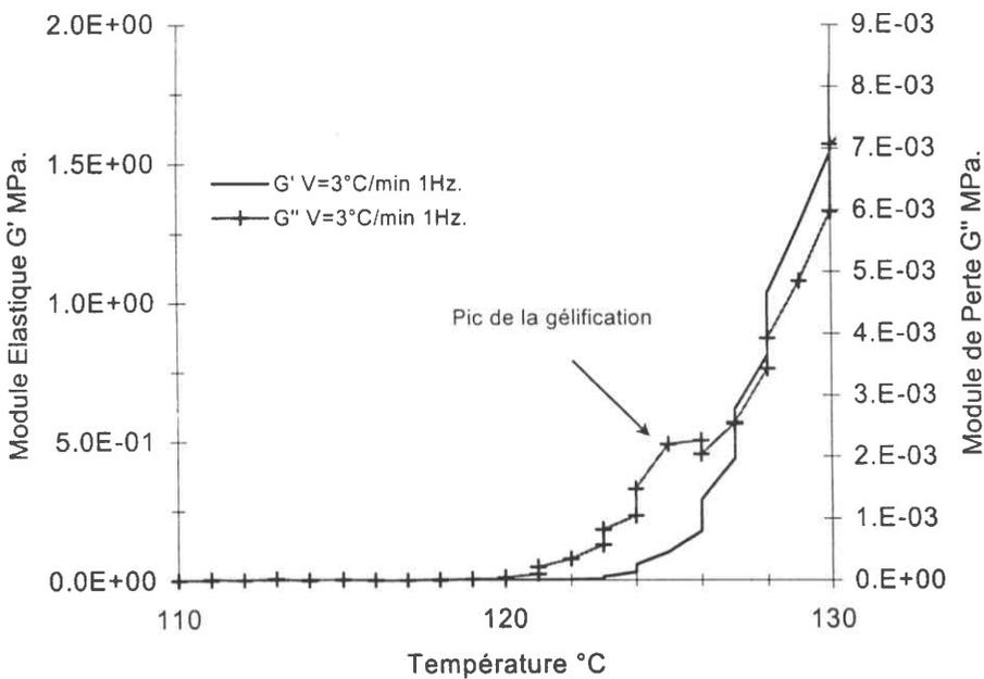
Figure II-26 : Evolution durant la phase de gélification des modules de cisaillement élastique  $G'$  et de perte  $G''$  de la résine époxy au cours d'une montée en température à  $3^\circ C/min$ . puis maintenue à  $180^\circ C$ .
