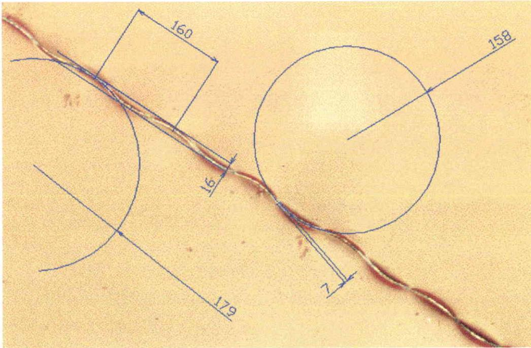
Figure III-1 : Exemple de relevé de microflambage (en microns) effectué sur une fibre de carbone T300 placée dans une matrice époxy LY556.
