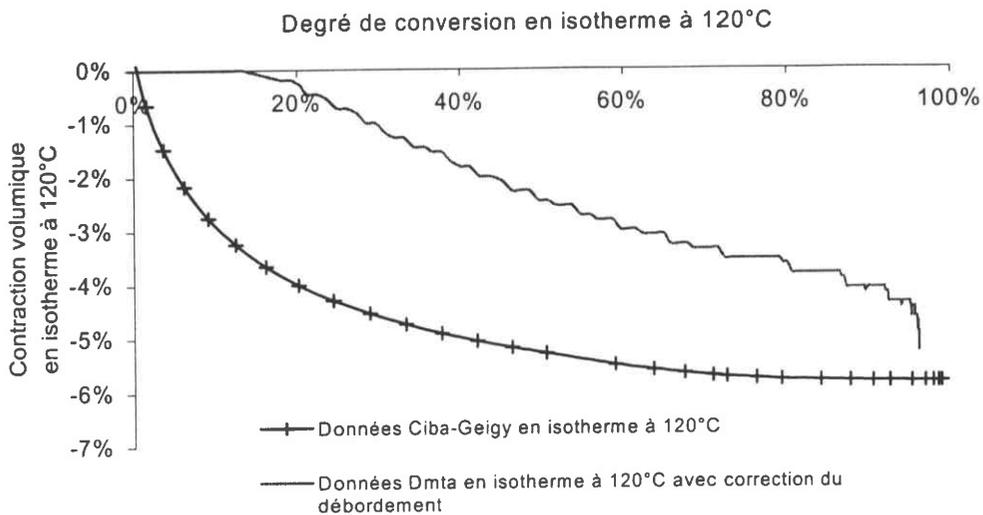
Figure II-37 : Comparaison des contractions volumiques en isotherme à 120°C fournies par la DMTA, avec correction due au débordement, et par CIBA-GEIGY, en fonction du degré de conversion.
