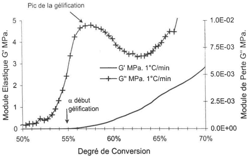
Figure II-22 : Evolution durant la réaction de la gélification des modules de cisaillement élastique  $G'$  et de perte  $G''$  de la résine époxy au cours d'une montée en température à  $1^\circ\text{C}/\text{min}$ . en fonction du degré de conversion (fréquence 1Hz).
