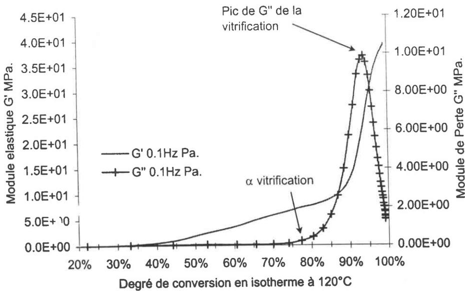
Figures II-29 : Evolutions des modules de cisaillement élastique  $G'$  et de perte  $G''$  de la résine époxy au cours de l'isotherme à 120°C, en fonction du temps et en fonction du degré de conversion.
