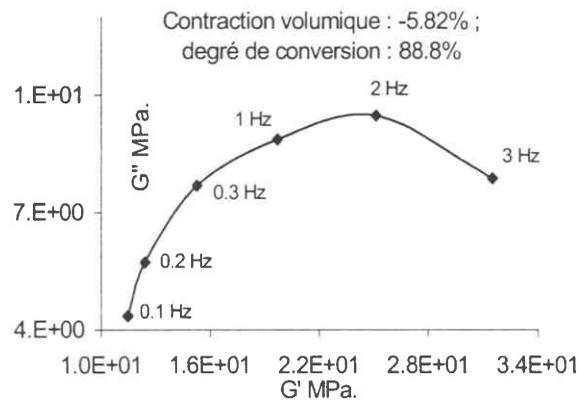
Figure II-47 : Exemple de diagramme de Cole-Cole obtenu lors de la cuisson en isotherme à 120°C et dont l'allure est assimilable à celui d'un modèle de Zener bi-parabolique.
