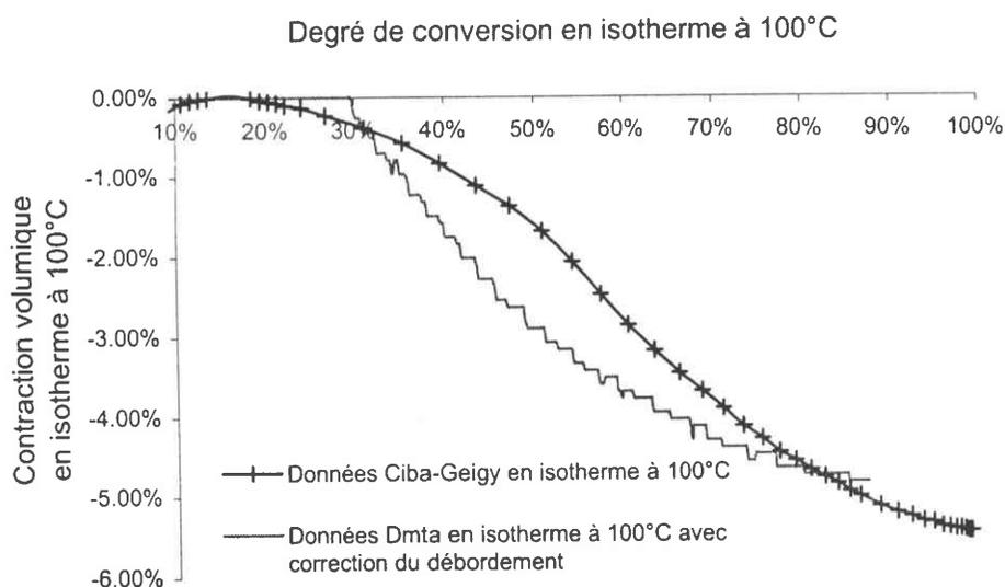
Figure II-35 : Comparaison des contractions volumiques en isotherme à 100°C fournies par la DMTA, avec correction due au débordement, et par CIBA-GEIGY, en fonction du degré de conversion.
