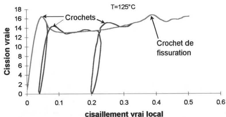
Figure I-11 : Traçé comparatif du cisaillement de la matrice à 125°C avec et sans charges et décharges intermédiaires.
