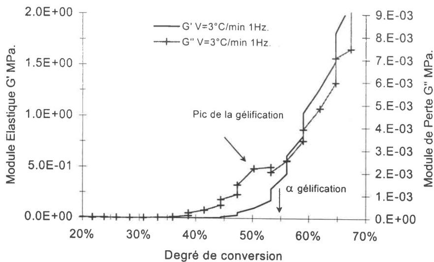
Figure II-28 : Evolution durant la réaction de la gélification des modules de cisaillement élastique  $G'$  et de perte  $G''$  de la résine époxy au cours d'une montée en température à  $3^\circ\text{C}/\text{min}$ . puis maintenue à  $180^\circ\text{C}$ , en fonction du degré de conversion.
