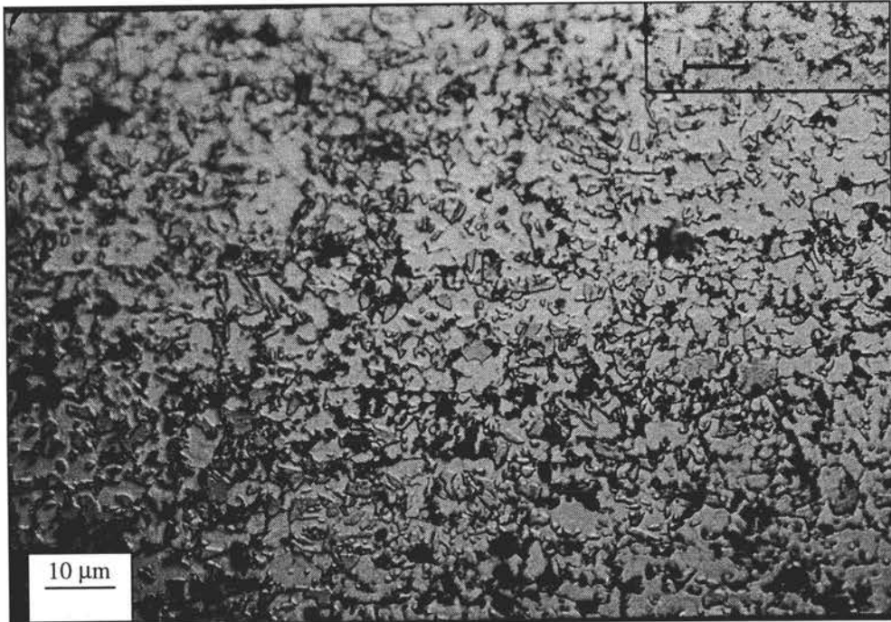
figure 2-6: microstructure de l'acier recuit (recuit intercritique à 800 °C)
