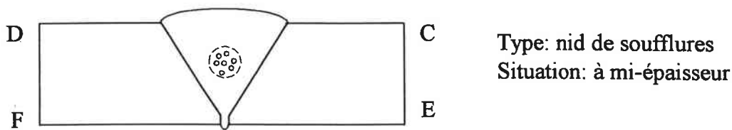
Figure V-5: Défaut 1 - Pièce E1 - Nid de soufflures
