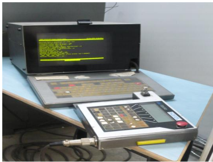
Figure I-8 : a) Panel de contrôle et de pilotage du générateur et du robot
