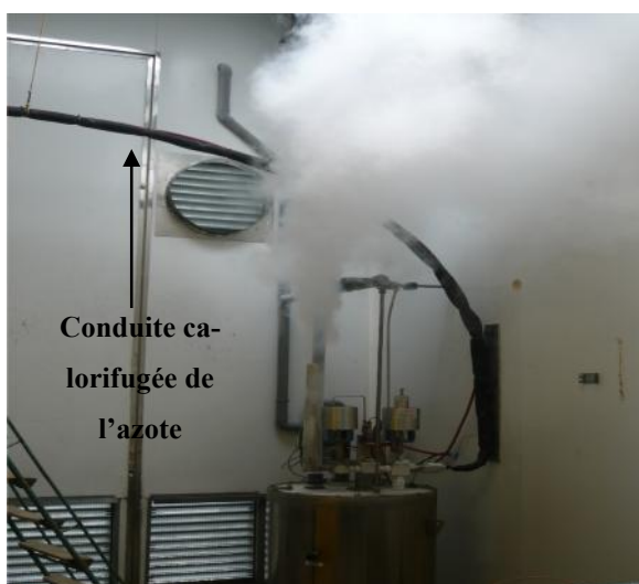
Figure I-7 : Second échangeur de chaleur avec conduite de chaleur vers la buse de projection
