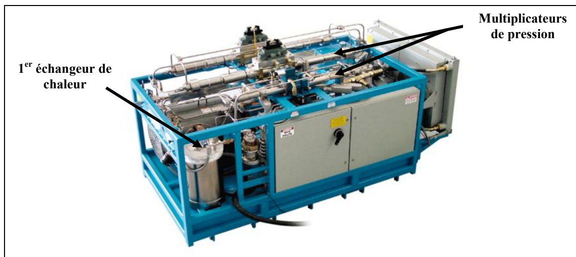
Figure I-5 : Photo du générateur d'azote haute pression (NITAJET 6000). Dimensions : 2.90m, 1.22m et 1.65m. Poids : 3600Kg
