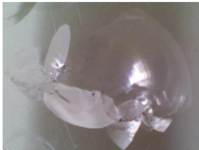
Figure II-3 : Impact sur un bloc de PMMA ; d_{\text{tir}}=60\text{mm} , t_{\text{expo}}=1\text{s} et P_c=300\text{MPa}
