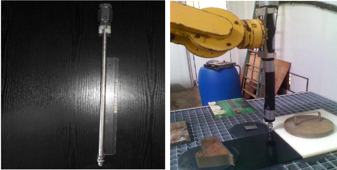
Figure I-14 : Outil (ou porte-buse) de travail durant toute cette étude avant et après calorifugeage
