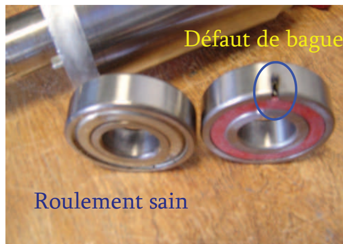
Fig. I.23 : Vue des roulements sains et défectueux (bague cassée)
