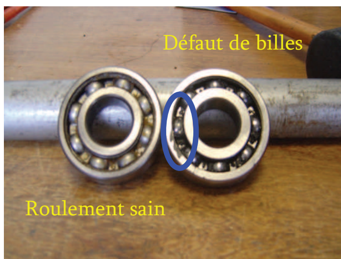
Fig. I.27 : Vue des roulements sains et défectueux (billes écorchées)
