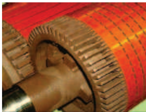
Fig. I.5 : Rotor à barres de cuivre
