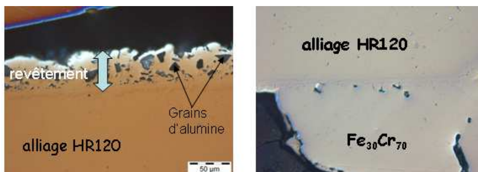
Figure V-15 : micrographies optiques de l'alliage HR120 après chromisation in pack à 1000°C pendant 16h à partir du ciment « 75 wt.% Cr 70 Fe 30 + 25wt.% Al 2 O 3 + 17 mg CrCl 3 »
