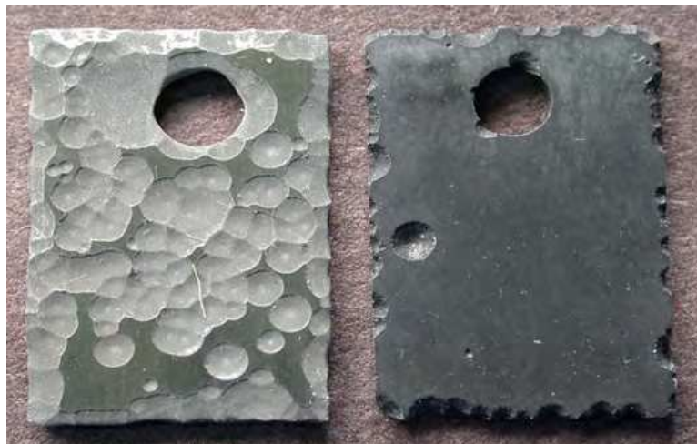
Figure 0-5 : Echantillons d'Inco 600 (à gauche) et 601 (à droite) après 12 858 h d'exposition à une atmosphère de Metal Dusting à 593°C sous 1 atmosphère [6]
