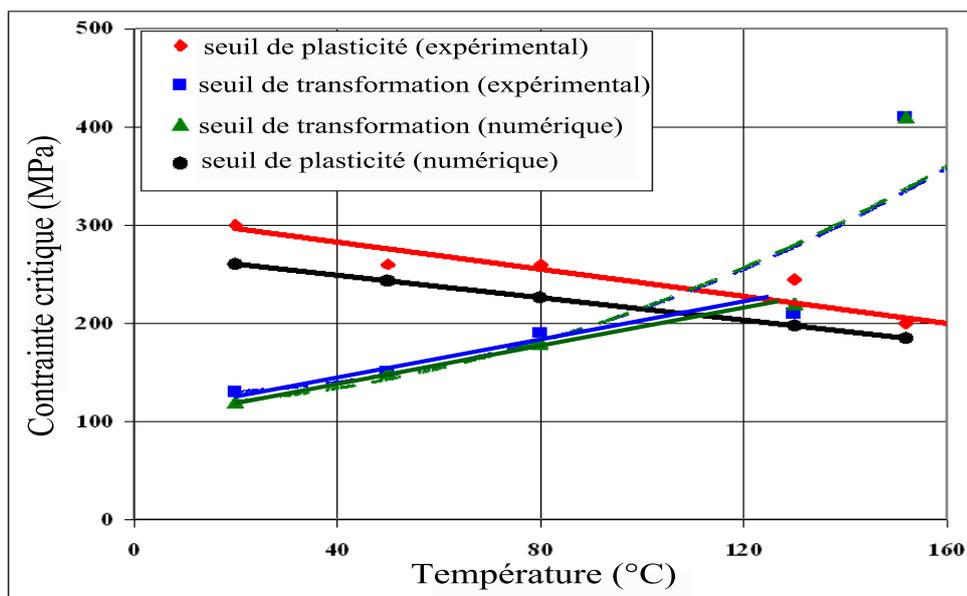
FIGURE 4.35 – Comparaison entre les diagrammes numérique et expérimental de contraintes critiques
