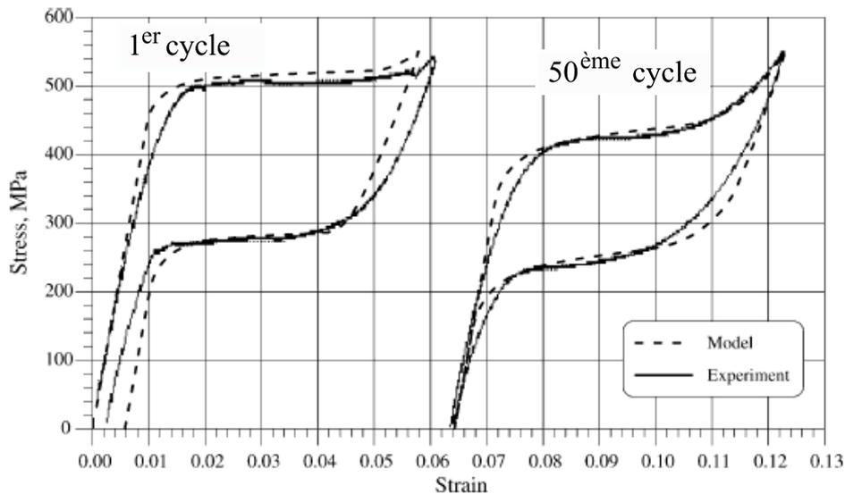
FIGURE 1.22 – Courbes du chargement cyclique au 1<sup>er</sup> et au 50<sup>ème</sup> cycle, à la température 46°C, d'après [43]
