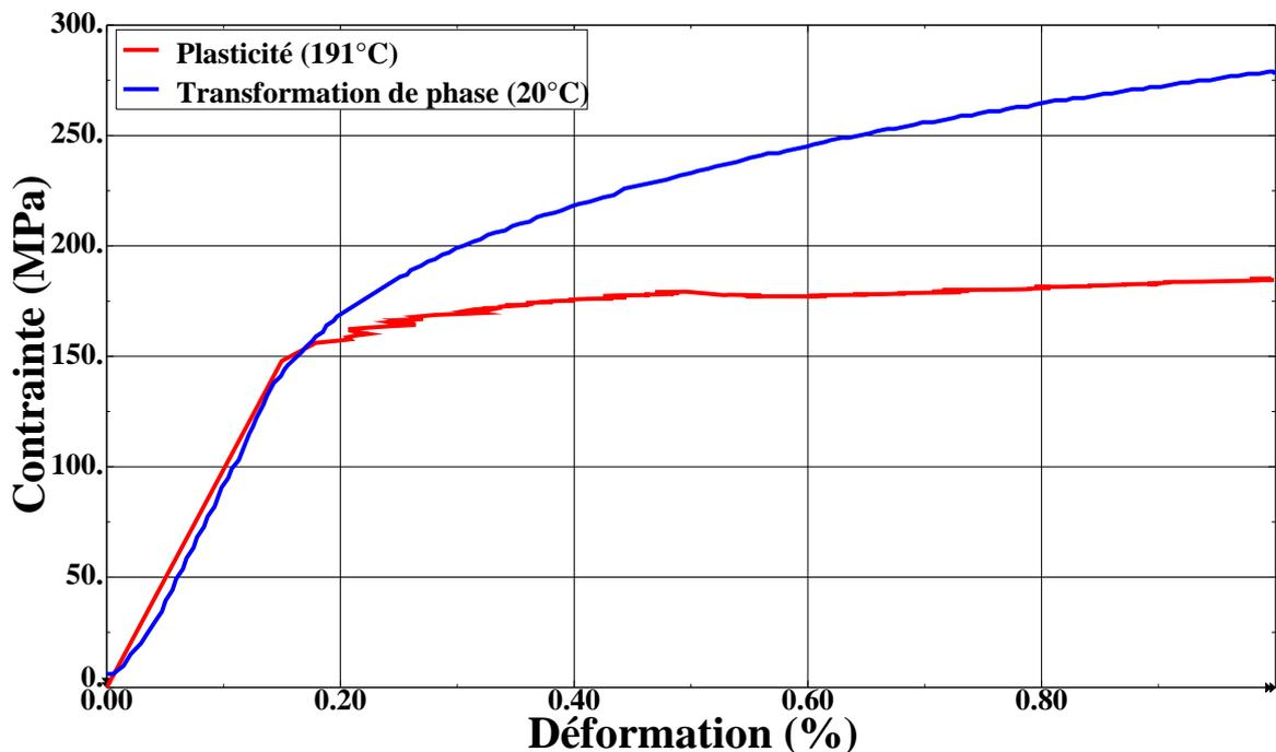
FIGURE 2.13 – Variation de la non linéarité entre la transformation de phase à 20°C et la plasticité à 191°C
