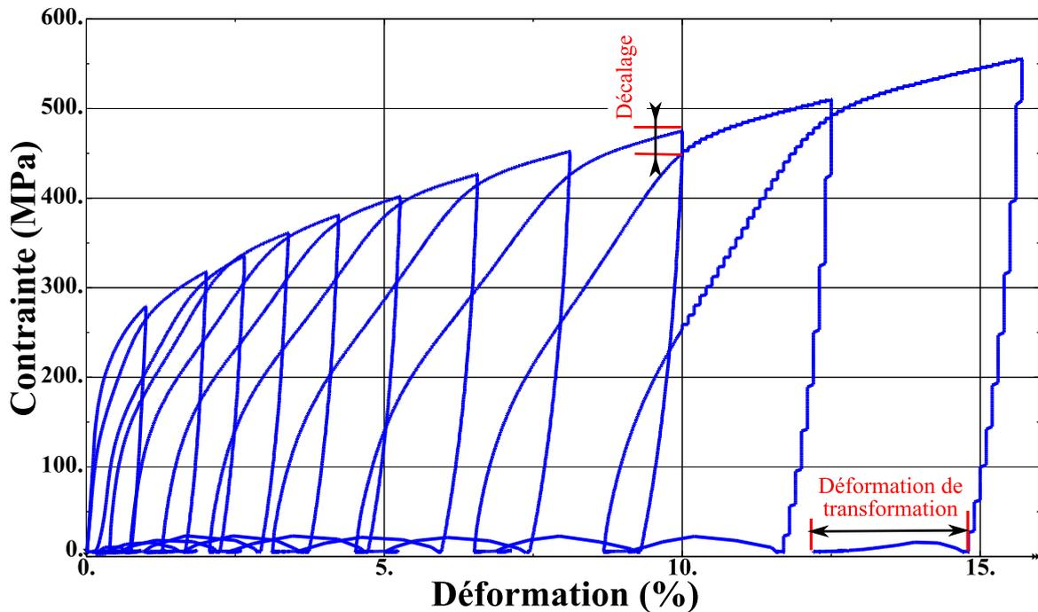
FIGURE 2.7 – Courbe contrainte - déformation : cycles de charge - décharge - chauffage ( $T = 20^{\circ}\text{C}$ )
