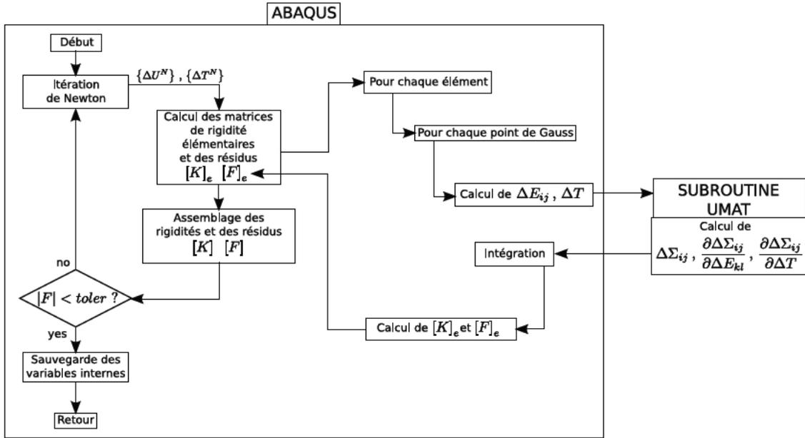
FIGURE 5.1 – Principe de la résolution par EF (d’après [22]).
