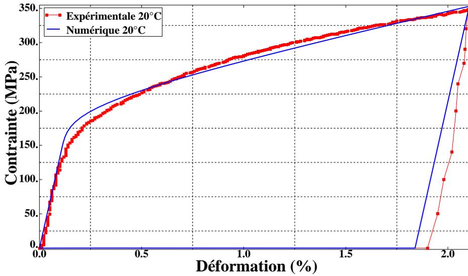
FIGURE 4.36 – Comparaison entre les résultats expérimentaux et numériques à 20°C (AMFe-2)
