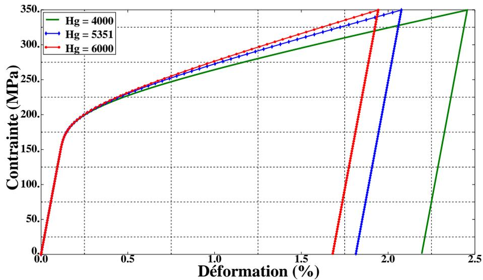
FIGURE 4.6 – Influence du paramètre  $H_g$  (MPa) sur le comportement à 20°C (AMFe-2)
