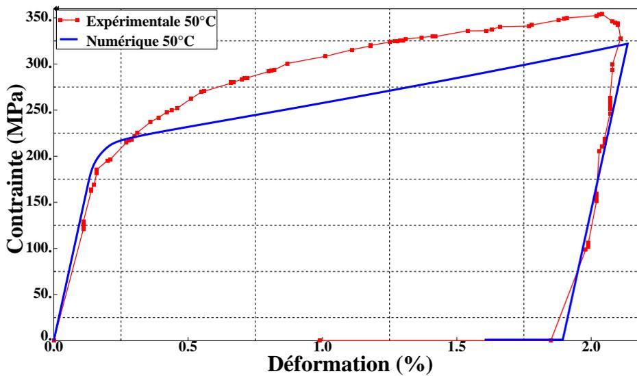
FIGURE 4.37 – Comparaison entre les résultats expérimentaux et numériques à 50°C (AMFe-2)
