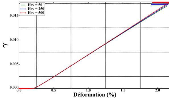
(a) Effet de  $H_{sv}$  sur le taux de la plasticité
