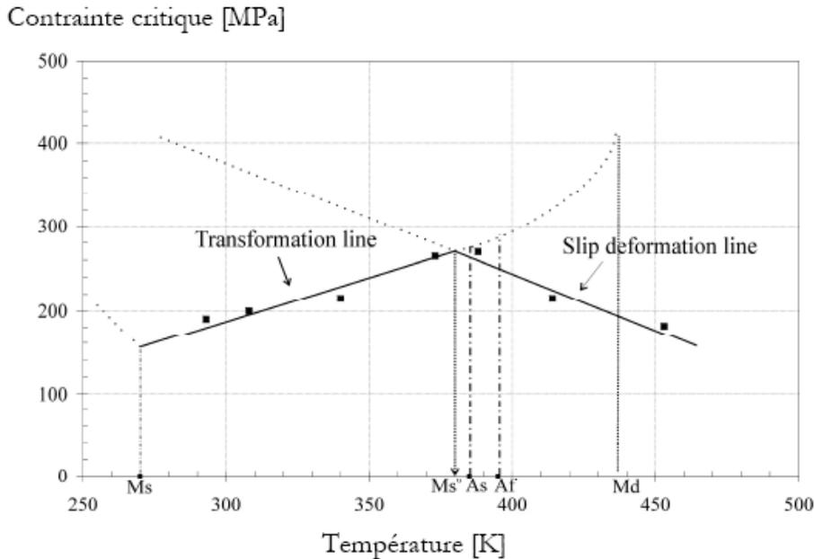
FIGURE 1.1 – Diagramme de l'évolution de contraintes critiques induisant une déformation inélastique en fonction de la température, d'après [12]
