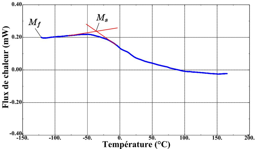
FIGURE 2.3 – Identification des températures de transformation martensitique directe
