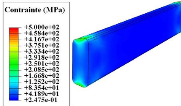
FIGURE 5.28 – Distribution de la contrainte équivalente de von Mises avant chauffage
