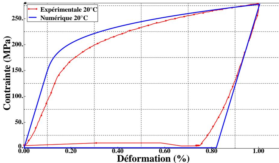
FIGURE 4.23 – Comparaison entre les résultats expérimentaux et numériques à 20°C (matériau AMFe-1)
