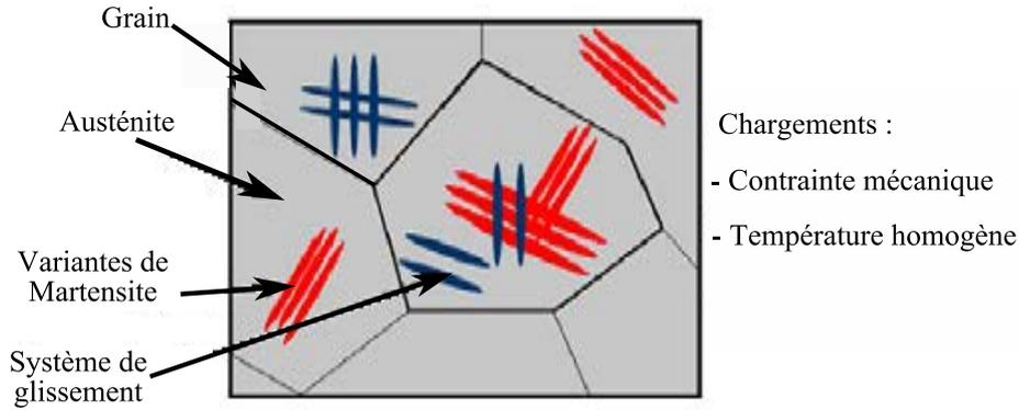
FIGURE 3.3 – Volume élémentaire représentatif d'un AMF à base fer polycristallin
