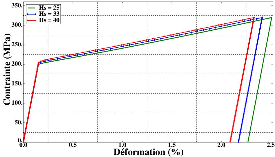
FIGURE 4.16 – Influence du paramètre  $H_s$  (MPa) sur le comportement à  $130^\circ\text{C}$  (AMFe-2)
