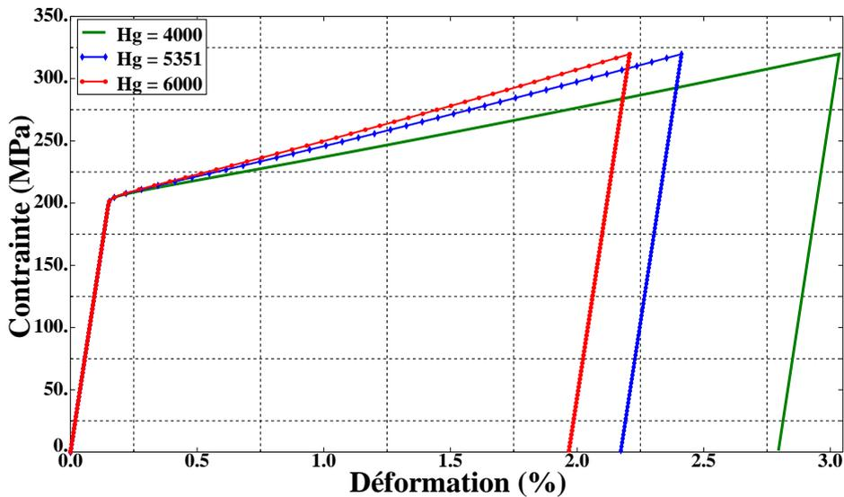
FIGURE 4.9 – Influence du paramètre  $H_g$  (MPa) sur le comportement à 130°C (AMFe-2)
