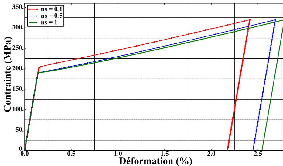
FIGURE 4.17 – Influence du paramètre  $n_s$  sur le comportement à  $130^\circ\text{C}$  (AMFe-2)
