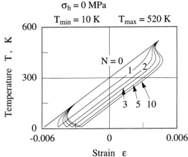
FIGURE 1.15 – Stabilisation de l'effet mémoire de forme avec le traitement cyclique de conditionnement, d'après [55]
