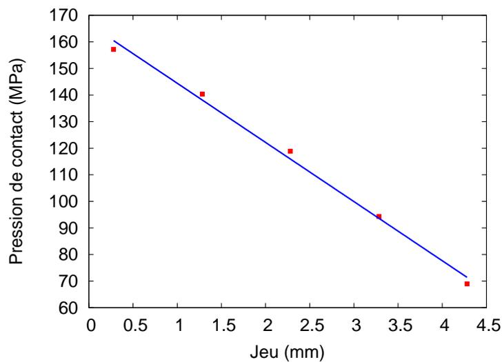
FIGURE 5.36 – Effet du jeu initial sur la pression de contact (résultats numériques)
