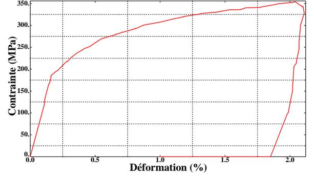
(b) Courbe de traction à 50°C (couplage entre la transformation et la plasticité), [34]
