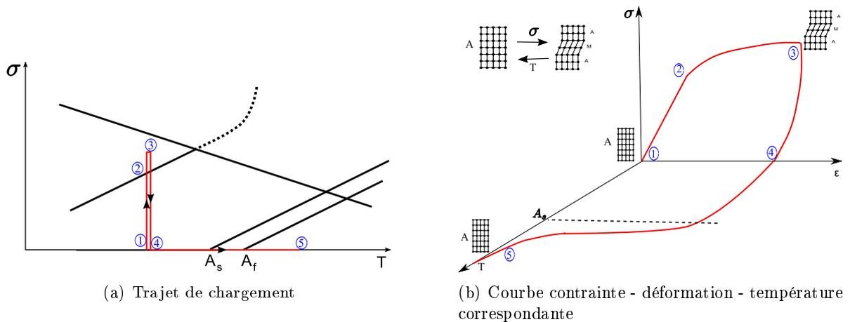
FIGURE 3.2 – Comportement thermomécanique des AMF à base fer
