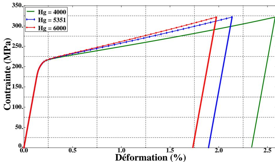
FIGURE 4.7 – Influence du paramètre  $H_g$  (MPa) sur le comportement à 50°C (AMFe-2)
