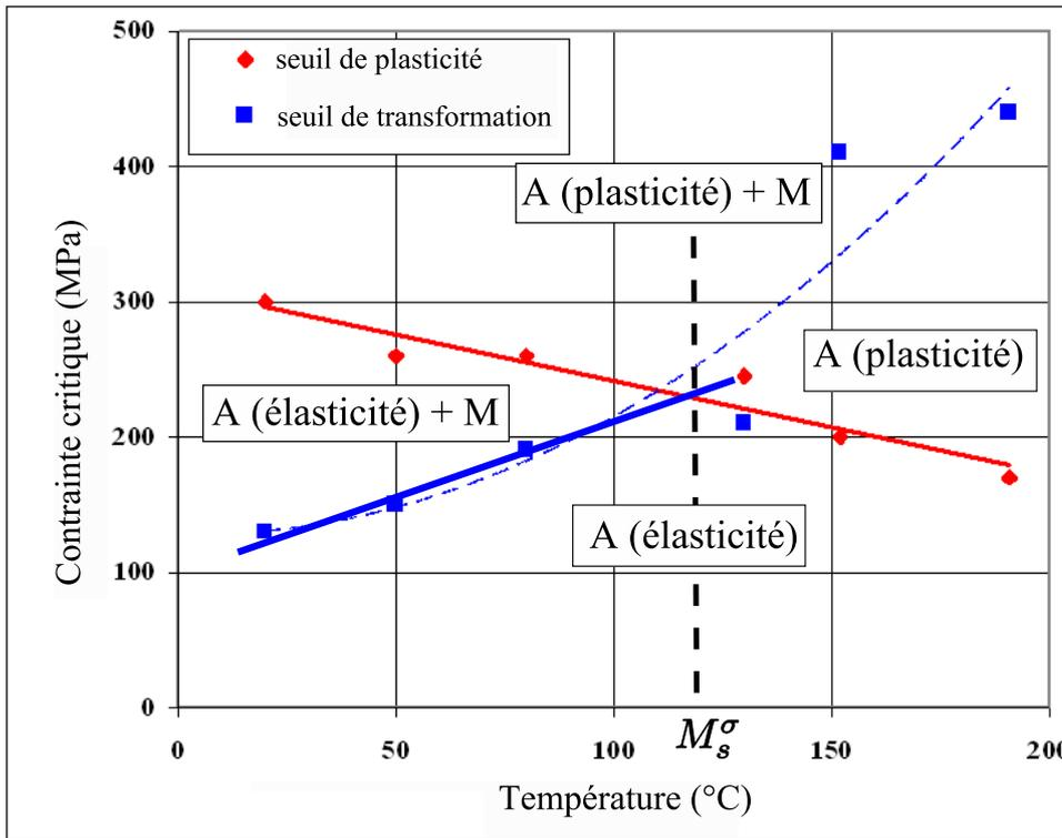
FIGURE 2.20 – Diagramme contrainte critique / température (A=austénite, M=martensite)
