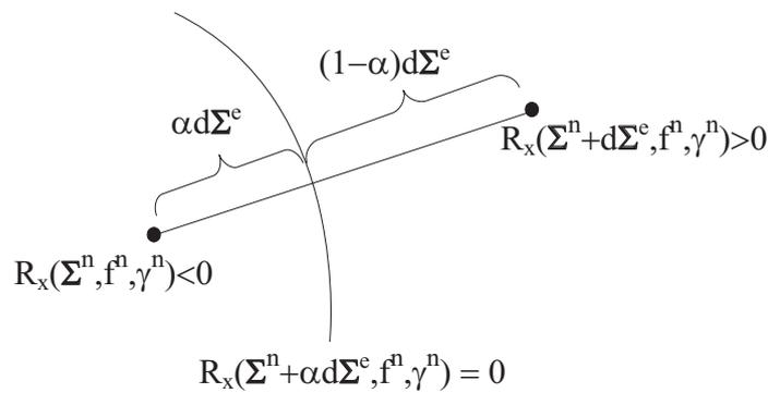
FIGURE 4.1 – Détection de l'activation d'un mécanisme de déformation.
