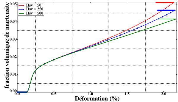
(b) Effet de  $H_{sv}$  sur la fraction volumique de martensiteFIGURE 4.19 – Effet de  $H_{sv}$  (MPa) sur les deux mécanismes inélastique à 50°C (AMFe-2)4.3.4.h Influence de  $n_{sv}$
