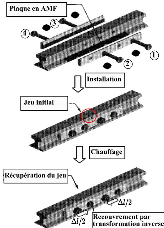
FIGURE 5.24 – Cycle de fonctionnement, d’après [51]
