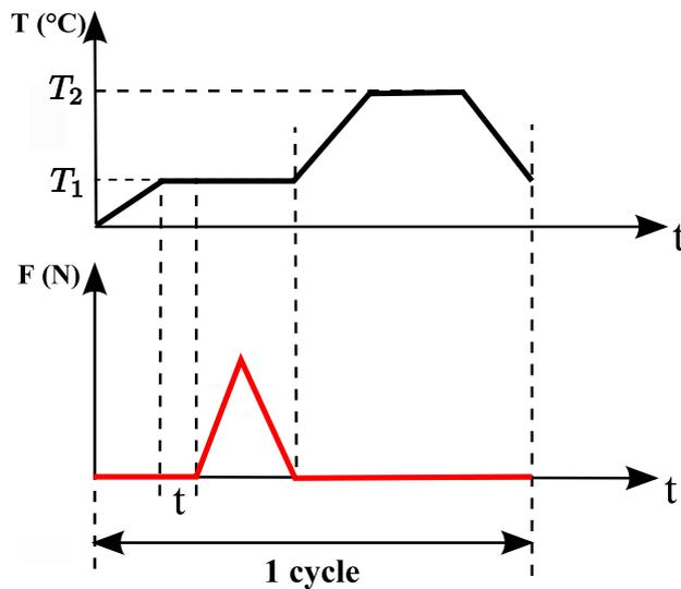
FIGURE 2.6 – Cycle de charge - décharge - chauffage - refroidissement
