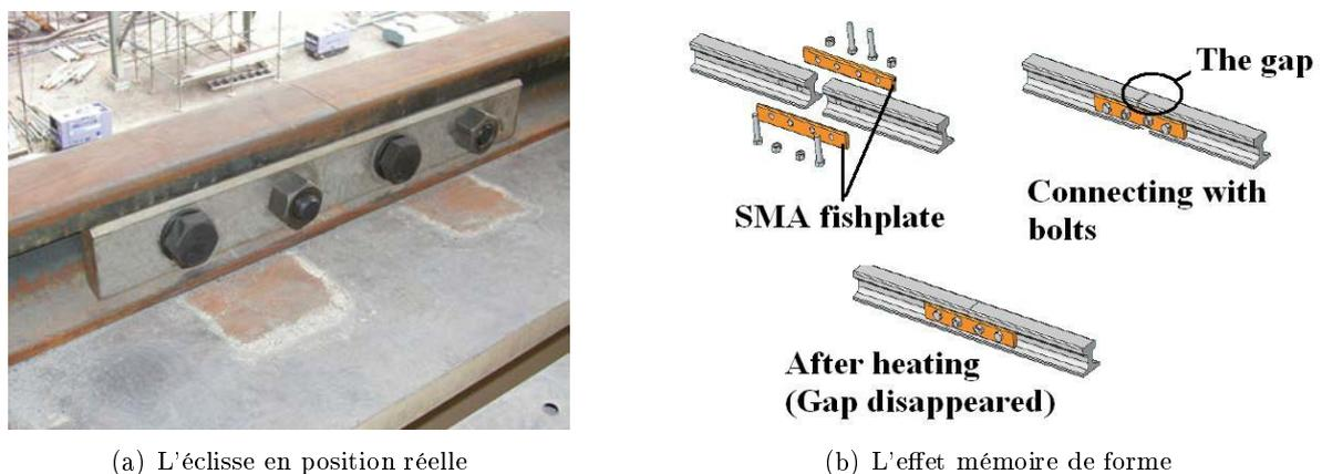
FIGURE 1.30 – Application industrielle de l'éclisse de jonction des rails, d'après [1]
