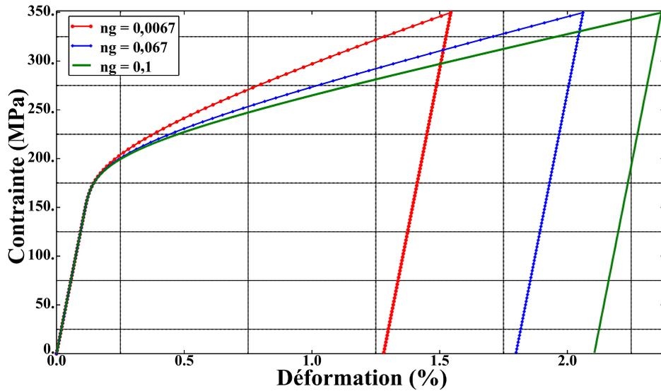
FIGURE 4.10 – Influence du paramètre  $n_g$  sur le comportement induit par la transformation seule à 20°C (AMFe-2)
