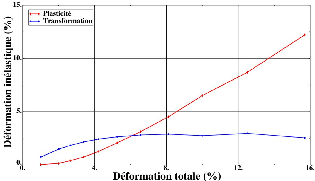
FIGURE 2.14 – Évolution de la déformation de transformation et de plasticité en fonction de la déformation totale ( $T = 20^\circ\text{C}$ )
