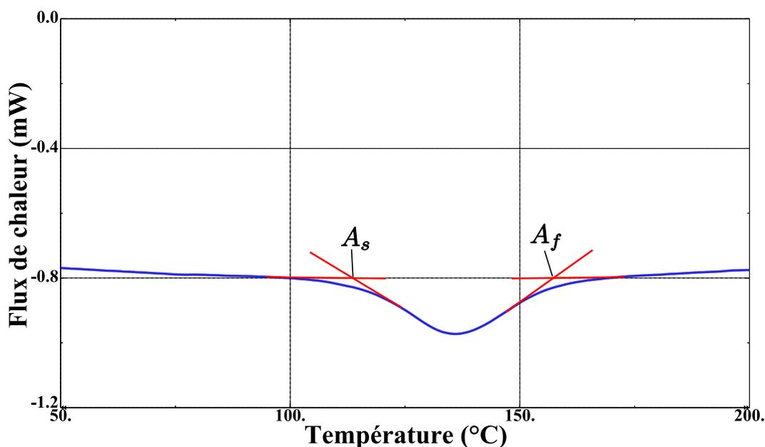
FIGURE 2.4 – Identification des températures de transformation inverse
