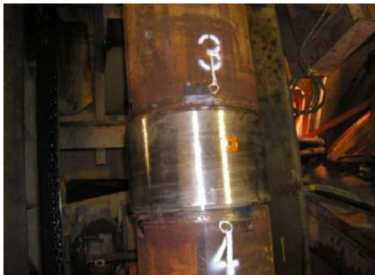
(a) Assemblage entre deux tubes 3 et 4 par la bague en AMF
