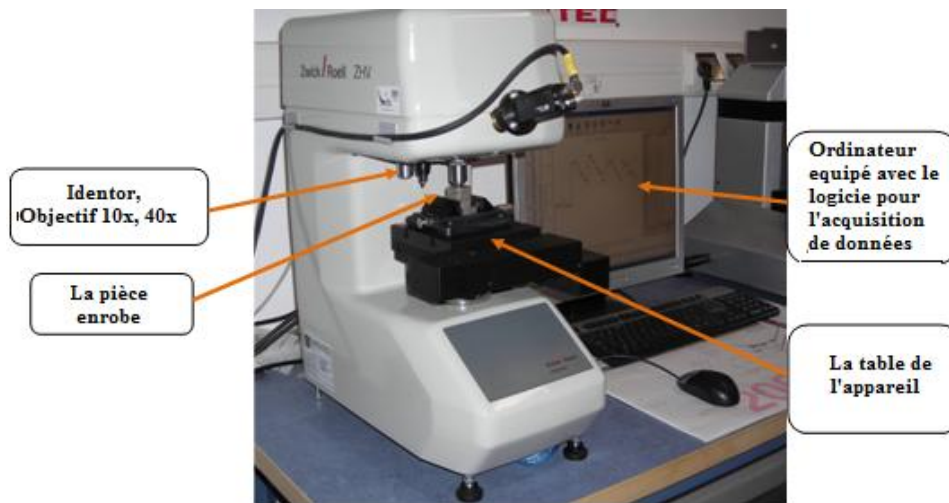
Fig. 3.21 Appareil de mesure de micro-dureté Zwick/Roell ZHV
