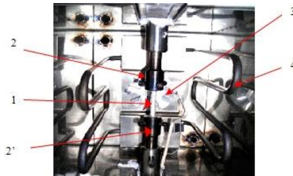
Fig. 2.2 Montage expérimental utilisé pour les essais de torsion
