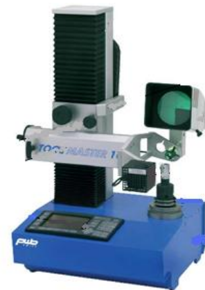
Fig. 3.16 Le projecteur de profil Toolmaster 310-P
