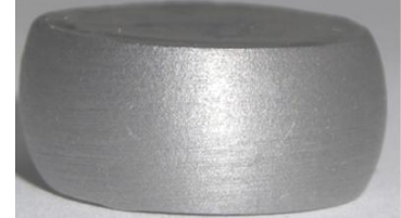
Fig. 2.10 Eprouvettes obtenues en fin d'essai de compression
