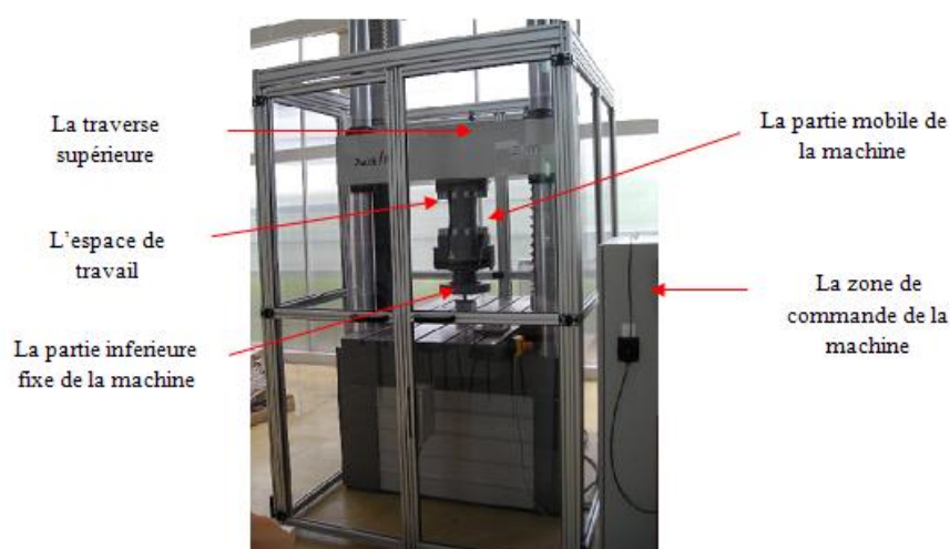
Fig. 2.4 Machine de traction-compression utilisée pour les essais de compression
