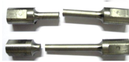
Fig. 2.9 Eprouvettes obtenues en fin d'essai de torsion
