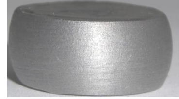
Fig. 2.10 Eprouvettes obtenues en fin d'essai de compression
