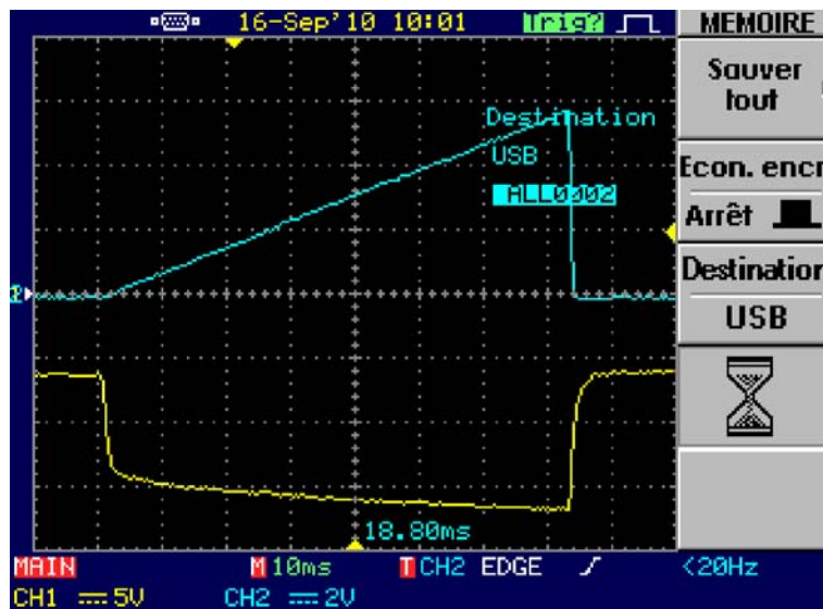
FIGURE 5.51 – Relevés de la caractéristique inverse de la même cellule à l’aide du testeur automatique. La courbe bleue est l’image du courant circulant dans la cellule. La courbe jaune correspond à la tension aux bornes de la cellule.
