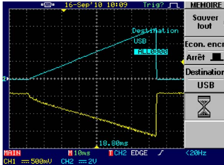
FIGURE 5.50 – Relevés de la caractéristique directe d’une cellule à l’aide du testeur automatique. La courbe bleue est l’image du courant circulant dans la cellule. La courbe jaune correspond à la tension aux bornes de la cellule.
