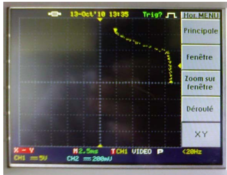
FIGURE 5.52 – Relevés de la caractéristique d'un panneau de 18V à l'aide du testeur automatique.
