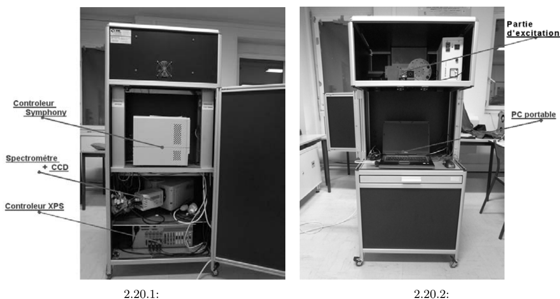
FIGURE 2.20 – Photographies des parties du système après leur intégration dans un rack transportable
