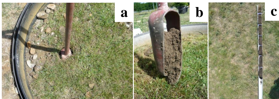
Figure 44 : Photographies du prélèvement dans les lysimètres, a) tarière, b) prélèvement d'un échantillon d'une hauteur de 15cm, c) disposition des échantillons destinés à être analysés dans une gouttière en plastique
